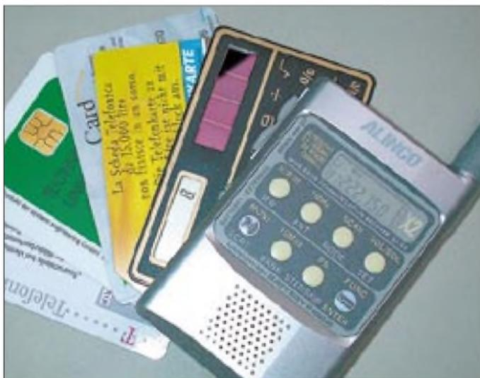
**Kein Kartentrick: Der Suchlaufempfänger DJ-X2E belegt nur die Fläche einer Scheckkarte, allerdings ist er deutlich stärker.**
