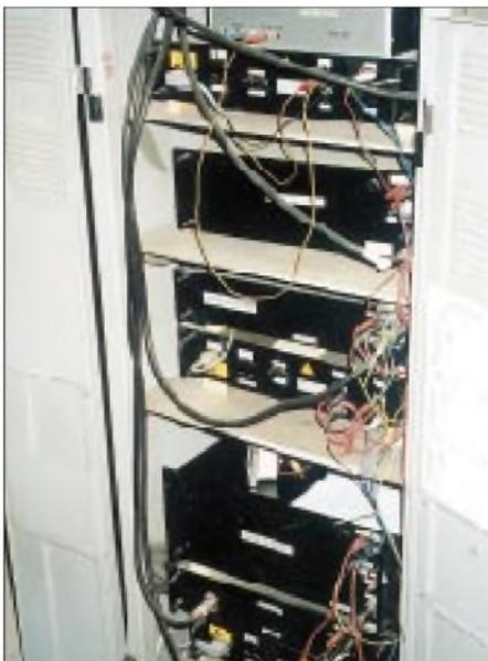
Dauerläufer-Technik von DL7APV für 144, 1296 und 432 MHz (v.u.n.o.). Fotos: DL7ACG und DL7YS
