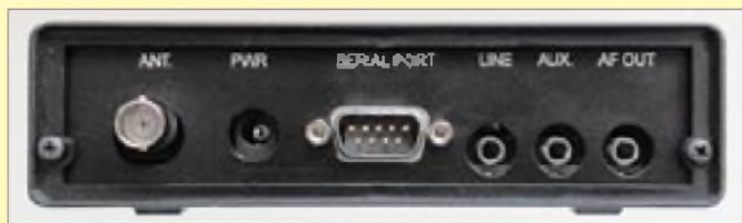
An der Rückseite der Blackbox befinden sich die wenigen Buchsen für Antenne, Stromversorgung, PC und Soundkarte. Fotos: FA
