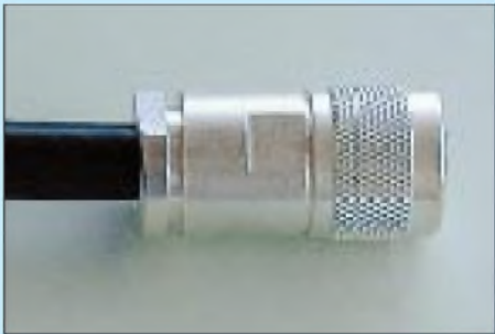
Bild 1: Aufschieben der Hülse und Festziehen mit passenden Maulschlüsseln beendet die Montage des N-Steckers UG-21STG und ähnlich aufgebauter Modelle.
