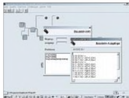
Digi-Board99 erlaubt das Erstellen und Testen digitaler Schaltungen am PC. Auch eigene Bauteile können mit ihren Eigenschaften definiert werden.
