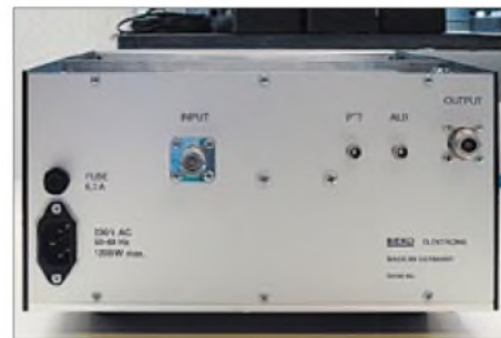
Bild 2: Die Rückansicht der HLV-600 läßt N-Buchsen für Ein- und Ausgang sowie Cinch-Buchsen für PTT und ALC erkennen.
