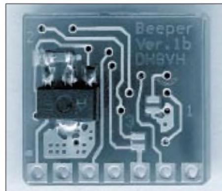
Bild 2: Die Rückseite des Moduls mit dem Spannungsregler – hier noch etwas größer
