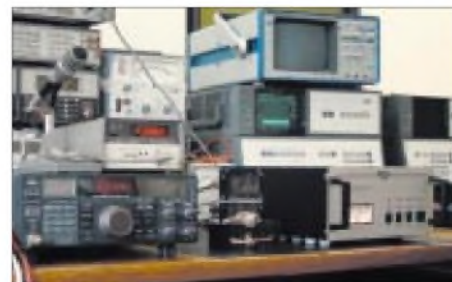
Bild 3: Meßaufbau mit TS-790; rechts im Hintergrund Spektrum-Analysator SNA-62 von W&G für die Messungen der Intermodulationsprodukte bzw. Nebenaussendungen [5].
