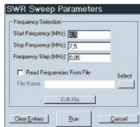
Bild 13: SWR Sweep Parameters: Eingabemaske für die Start- und Stoppfrequenzen sowie die Stufung zur Berechnung einer Wellenfeldstärkekurve s(f) . Getrennt erstellte Sweepdateien (Frequenzpunktdateien) können hier ebenfalls aufgerufen werden.
