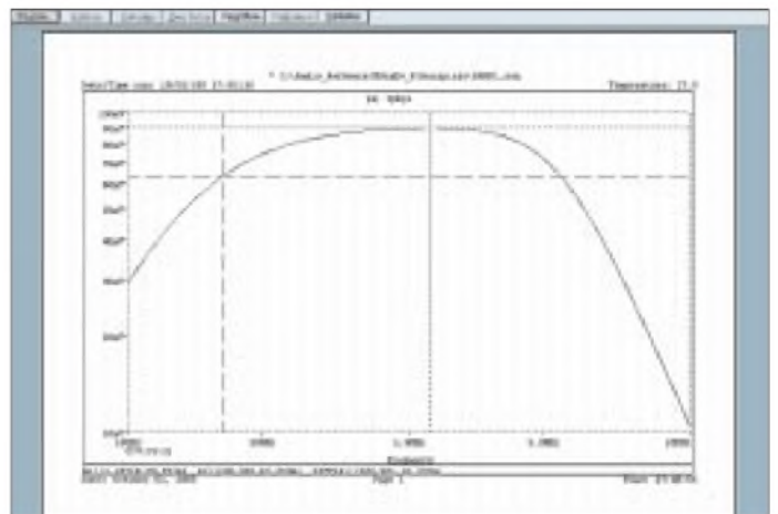
Bild 21: Screenshot der Simulation des NF-Bandpasses mit PSpice
