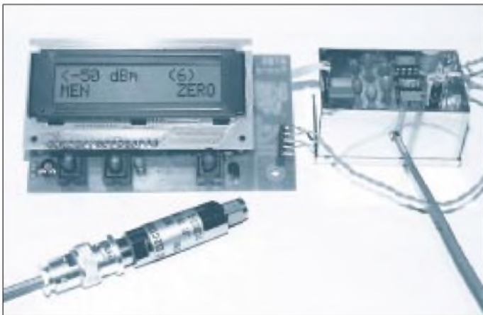
Bild 1: Die bestückten Baugruppen vor dem Einbau ins Gehäuse. Unterhalb des aufgesteckten Displays sind auf dem Prozessorboard die drei Taster zu erkennen.
