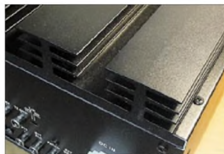
Bild 6: Markantester äußerer Unterschied zwi-schen Vorläufer und dem Mark-V sind vier die-ser markigen Kühlkörper auf der linken hinde-ren oberen Gehäusefläche zur Abführung der in der 200-W-Endstufe anfallen Verlustwärme. Übriges tut ein in Richtung Front angeordneter breiter, aber leiser Querstromlüfter.
