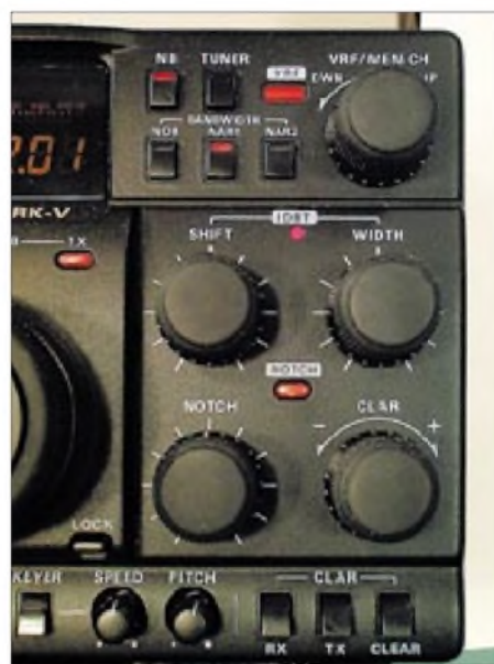
Bild 8: Die meisten weiteren Veränderungen zeigen sich im rechten Frontplattenabschnitt. Es wurde etliches vertauscht, die Störaus-tasterbedienung wanderte bis auf den Ein-schalter in die Menüebene, um u.a. Platz für die minimierte ZF-Filterumschaltung (wozu auch ein 250-Hz-Filter in der 3. ZF mit einem 2,4-kHz-Filter in der 2. kombinieren?) zu schaffen. Auch das Antennenabstimmgerät hat nur noch eine Taste. Vor allem stehen jetzt zwei große, separate, griffige Knöpfe für die Bedienung der Bandbreitenverstellung zur Ver-fügung. Eine zusätzliche Leuchtdiode signali-siert, ob dabei zusätzlich die IDBT wirksam ist. Oben rechts schließlich avancierte der Spei-cherauswahlknopf (nun dafür zu drücken) zum Einstellorgan für den neuen Preselektor.
