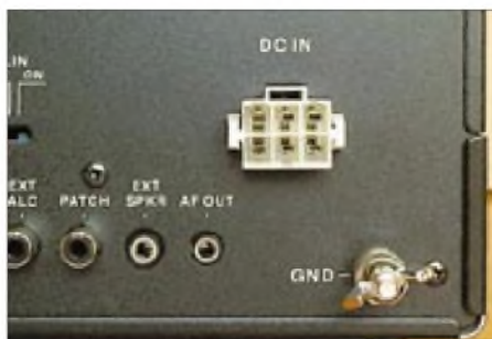
Bild 5: Einziger Rückfront-Unterschied zwi-schen Mark-V und nicht Mark-V: Netzbuchse sowie Sicherungselement fielen weg, und die 13,8-V-Standardbuchse wich einer ihr zwar sehr ähnlich aussehenden, ebenfalls sechspoligen, aber zu ihr doch verwechslungssicheren ande-ren Stromversorgungsbuchse.
