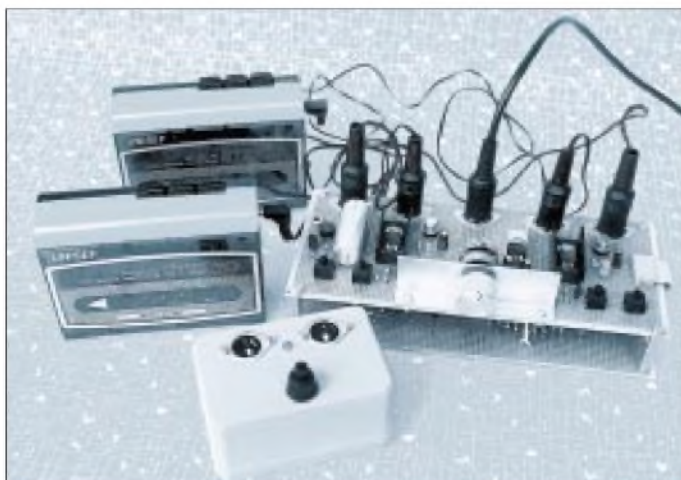
Bild 6: Musteraufbau, als Signalquellen dienen beim Autor zwei preiswerte Walkman-Geräte. Auf die Entwicklung einer speziellen Platine wurde verzichtet. Im Vordergrund sichtbar der Impulsgeber.
