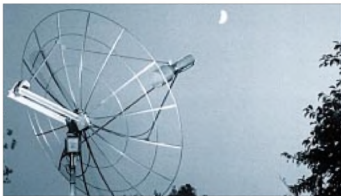
Bild 1: 23-cm-EME-Antenne von DJ9YW. Das Rauschmaß des nachfolgenden Empfangssystems beläuft sich auf 0,48 dB und repräsentiert das derzeit Machbare in diesem Frequenzbereich, vgl. a. [1].
