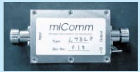
Bild 1: Modernster 70-cm-Vorverstärker mit 0,35 dB Rauschmaß Fotos: DG0ZB
