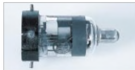
Bild 2: Die RV12P2000 stammt aus den vierziger Jahren und wurde nach dem Krieg gern in Amateurschaltungen bis in den UKW-Bereich eingesetzt. Fotos: Red. FA (2)
