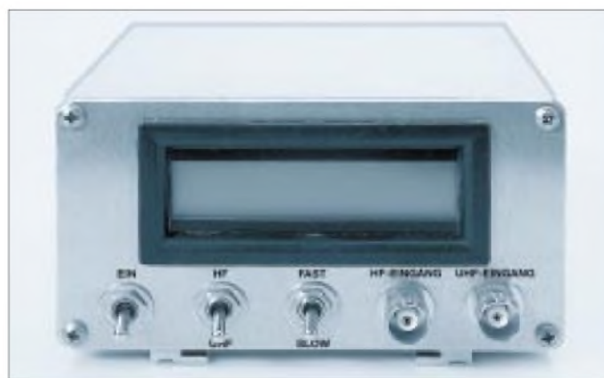
Bild 4: In das Original-Aluminium- gehäuse von AADE eingebautes DFD-4
