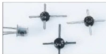
Bild 4: Links ein Germanium-Transistor aus den sechziger Jahren, daneben rauscharme Dual-Gate-FET BF981 aus den Achtzigern, wie sie für 2-m-Vorverstärker auch heute noch völlig ausreichend sind.
