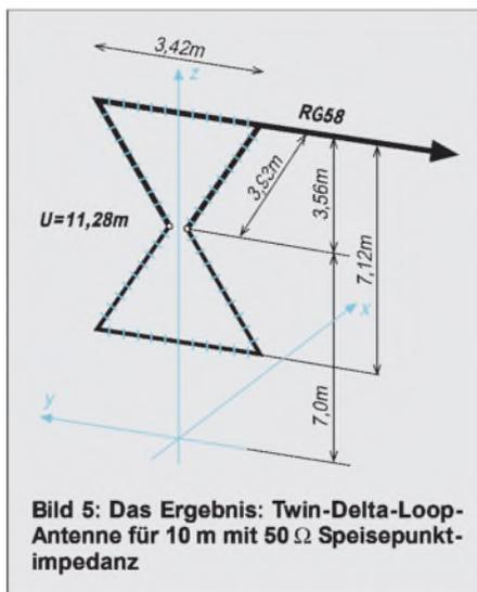
**Bild 5: Das Ergebnis: Twin-Delta-Loop-Antenne für 10 m mit  $50 \Omega$  Speisepunktimpedanz**
