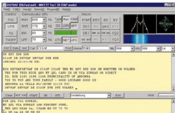
**Bild 1:** Screenshot von MMTTY. Rechts oben Sichtrohre, Spectrum- und Wasserfallanzeige. Links davon selbstdefinierbare Knöpfe für Textbausteine, in der Mitte das Empfangs- und darunter das Sendefenster.
