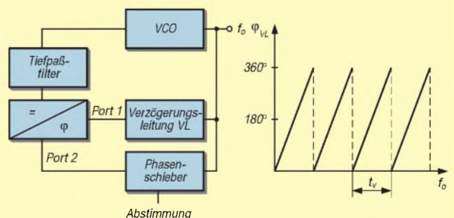
**Bild 7:** Prinzipielle Funktionsweise einer PLL mit Verzögerungsleitung
