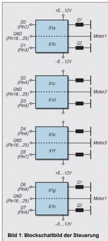
Bild 1: Blockschaltbild der Steuerung
