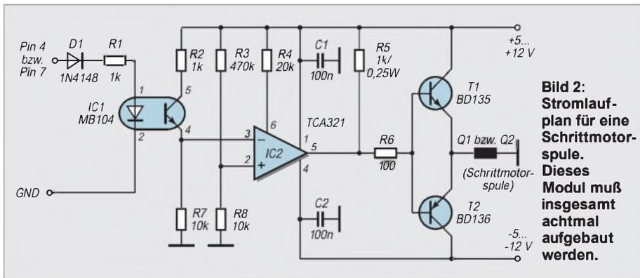
**Bild 2:** Stromlaufplan für eine Schrittmotorspule. Dieses Modul muß insgesamt achtmal aufgebaut werden.
