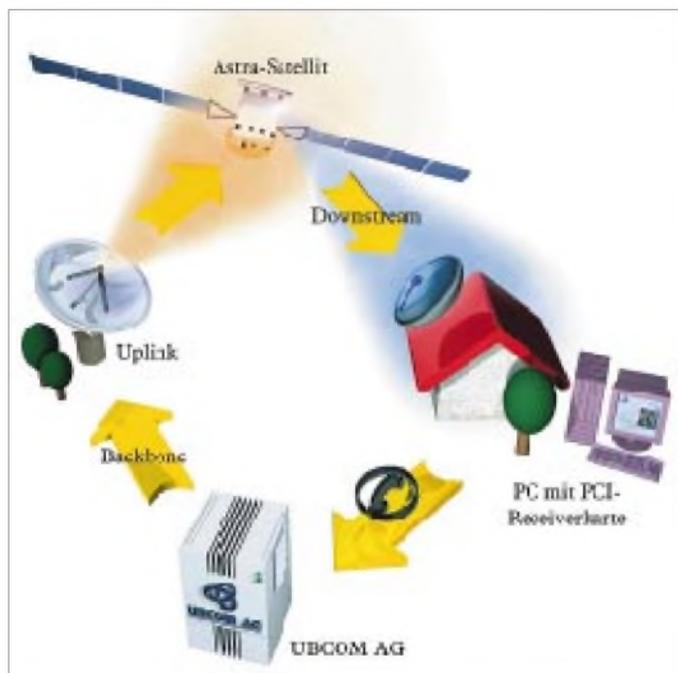
**Bild 1:** Internet per Satellit nutzt Basisstationen mit Satellitenschnittstellen auf der Senderseite (Uplink), welche sämtliche Aufgaben der Datenübertragung über einen direkt sendenden Satelliten übernehmen. Der Anwender empfängt via Sat-Schüssel die eintreffenden Datenströme und verarbeitet sie im PC. Als Rückkanal zum Provider dient ihm dann ein ganz normaler ISDN-Anschluß oder eine analoge Telefonleitung per Modem.
