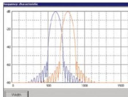
**Bild 2:** Frequenzgang der Bandfilter für Mark und Space, die sich freizügig an die eigenen Bedürfnisse anpassen lassen.
