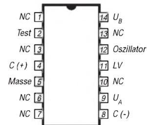
**Bild 2:** Pinbelegungen der Gehäuse
