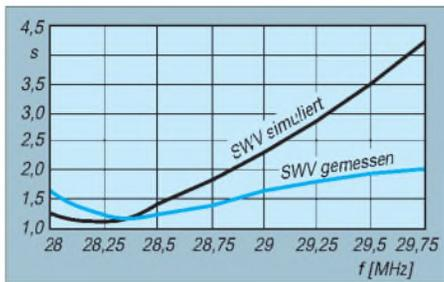
Bild 8: Simulierte und gemessene SWV-Werte der Twin-Delta-Loop-Antenne
