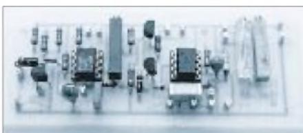
Bild 6: Die fertig bestückte Platine
