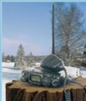
Der FT-817 von Yaesu dürfte im Segment der Geräte für geringe Sendeleistung (QRP), die bislang zumeist im Eigenbau, oft aus einem Bausatz, entstanden, für einiges Aufsehen sorgen: In den Amateurfunkbändern von 160 m bis 70 cm liefert er max. 5 W Sendeleistung in CW, SSB, AM, FM, Packet-Radio (auch mit 9k6), RTTY und wählbarer Digimode.
