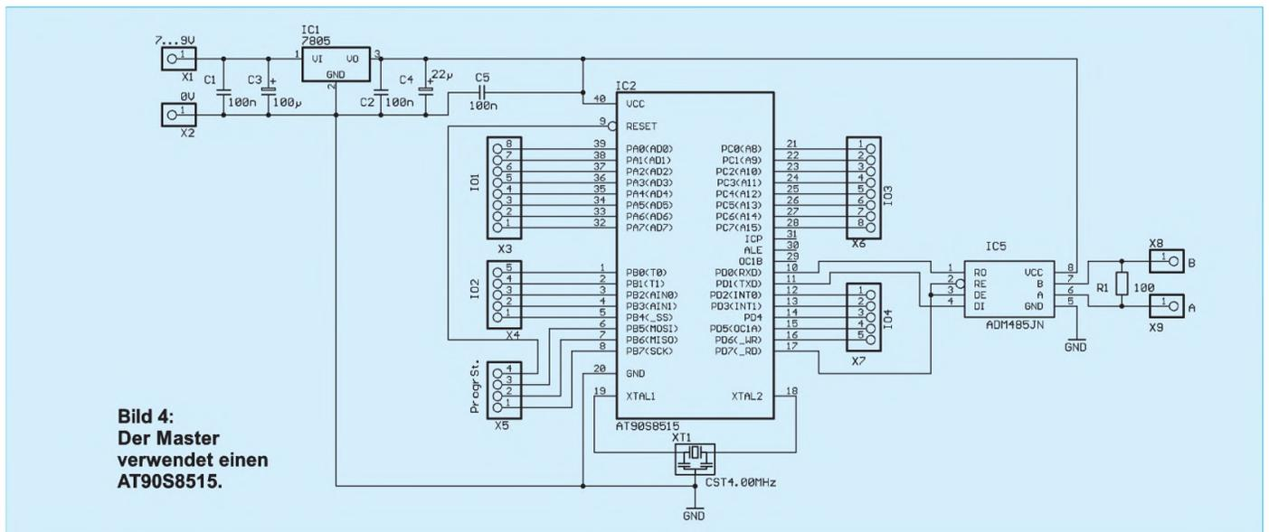
**Bild 4: Der Master verwendet einen AT90S8515.**
