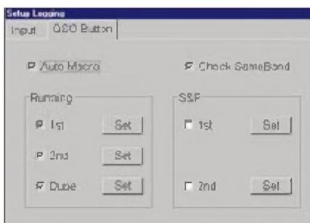
**Bild 5:** Diese Einstellung hat sich im Contestbetrieb bewährt. Die drei Textbausteine werden für die Begrüßung (*1st*), die Bestätigung (*2nd*) und für bereits geloggte Stationen (*Dupe*) verwendet.
