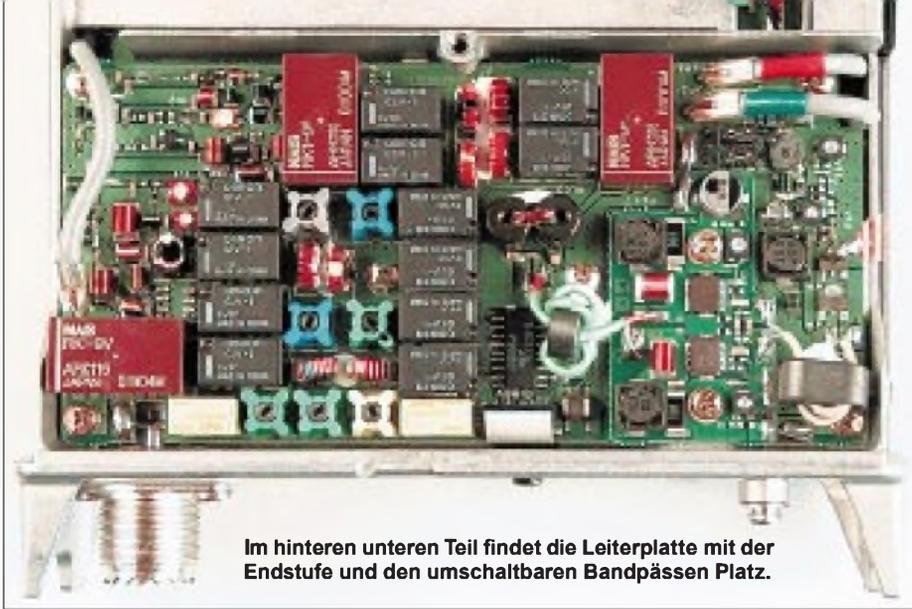
Im hinteren unteren Teil findet die Leiterplatte mit der Endstufe und den umschaltbaren Bandpässen Platz.
