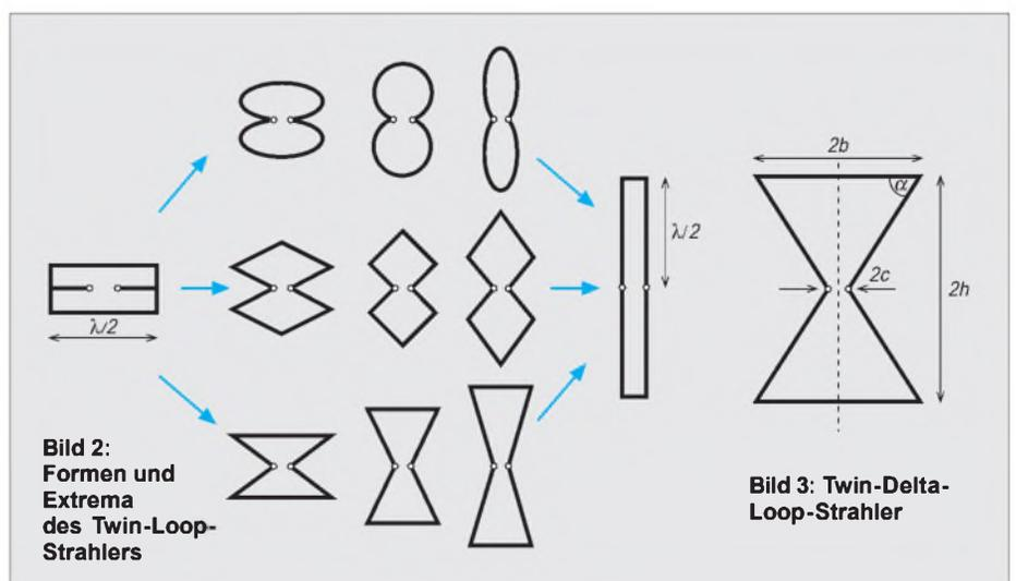
**Bild 2:** Formen und Extrema des Twin-Loop-Strahlers
