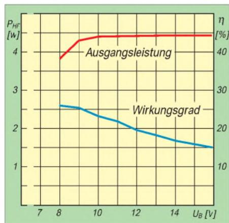
Die Ausgangsleistung bleibt bis herab zu 8 V relativ stabil. Der Gesamtwirkungsgrad steigt mit fallender Betriebsspannung.
