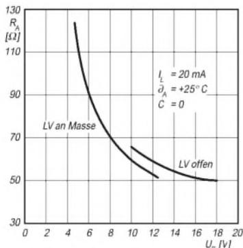
**Bild 3:** Ausgangswiderstand als Funktion der Betriebsspannung
