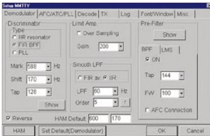
**Bild 3:** Setup-Menü – je nach der Leistungsfähigkeit des PC und den Empfangsbedingungen kann der Experimentierfreudige zwischen verschiedenen digitalen Filtertypen und Demodulationsverfahren wählen. Übertrieben steile Filter können zu Aussetzern im Sendesignal führen. *mmtty.ini* beinhaltet die Einstellungen.
