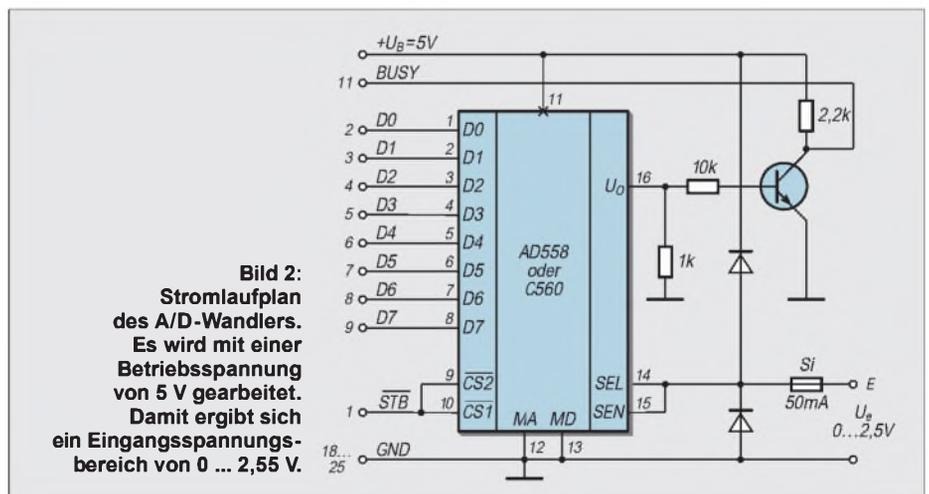
Der invertierende Eingang des internen „Komparators“ erhält die Eingangsspannung über eine Miniaturversicherung. Diese soll im Falle einer Eingangsspannung unter  $-0,7\text{ V}$  bzw. über  $5,7\text{ V}$  durch die dann leitenden Schutzdioden zum Schmelzen gebracht werden.
