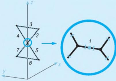
**Bild 4: Modell der Antenne für EZNEC; die kurzen Striche markieren die Zerlegung in einzelne Segmente. Um die Einspeisung nachzubilden, wurde ein fiktives Drahtstück 1 eingefügt, in drei Segmente zerlegt und mit einer Quelle versehen.**
