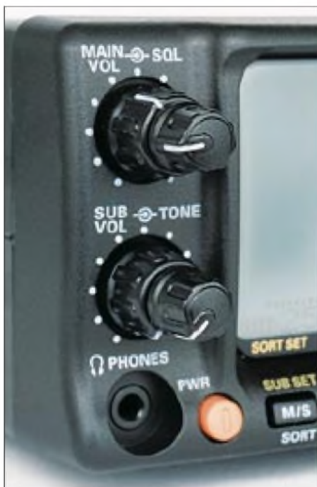
Doppelregler für die Wahl von Lautstärke, Rauschperre und Tonhöhe
