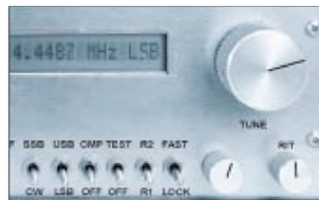
Bild 10: Unten in Bildmitte der Umschalter Fast/Lock, daneben der Drehknopf für die grobe Frequenzvorwahl, rechts unter der Hauptabstimmung der RIT-Knopf
