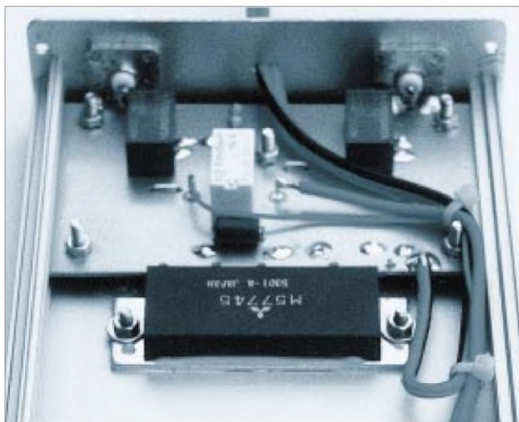
Bild 7: Linearendstufe mit Power-Modul von Mitsubishi, hier die 70-cm-Variante; zwischen den beiden HF-Relais ist das Relais für die Umschaltung der Versorgungsspannungen zu erkennen. Fotos: DJ8ES
