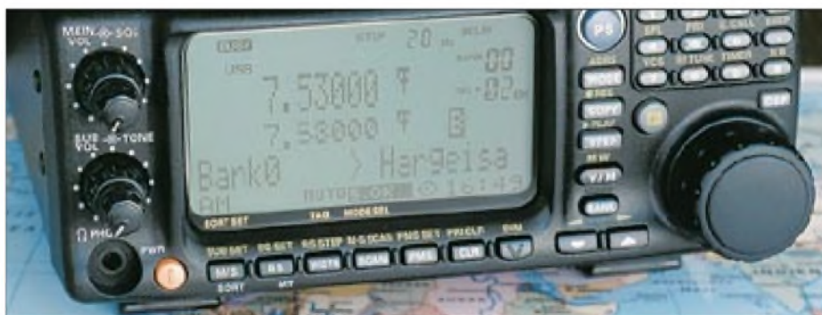
Zur besseren Übersicht können die 2000 Speicherkanäle alphanumerisch benannt werden, was den Wunsch nach einer Programmiersoftware aufkommen läßt.
