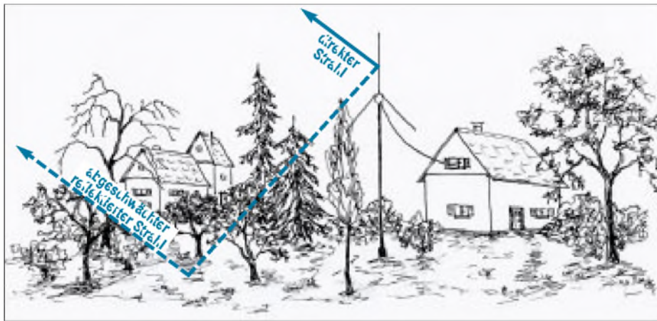
Bild 1: Bei realen Antennen wirkt der Erdboden als Reflektor mit. Bauwerke und Bäume können den zur destruktiven Interferenz mit dem direkten Strahl führenden reflektierten Strahl abschwächen und, besonders bei flachen Abstrahlwinkeln, die Feldstärke erhöhen (nach Moxon [3]). Zeichnung: I. Schick
