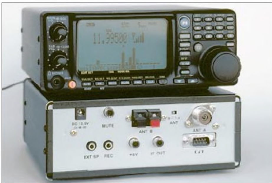
Ausgestattet mit fast allem, was das Herz des Scannerfreundes erfreut: Vorder- und Rückseite des Yaesu VR-5000.
