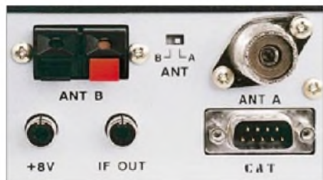
Die Rückseite des VR-5000 bietet neben zwei Antenneneingängen die bekannte CAT-Schnittstelle und einen ZF-Ausgang.
