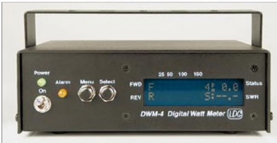
Bild 1: Das zweizeilige LC-Display am DWM-4 ermöglicht unterschiedlichste Anzeigen.
