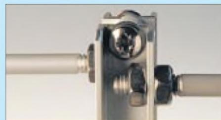
**Bild 8:** Montage eines  $\lambda/4$ -Elementteils an einer Boomstrebe Fotos: Red. FA
