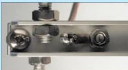
**Bild 7:** Der Innenleiter der Speiseleitung führt über eine Lötöse an die obere Boomstrebe.
