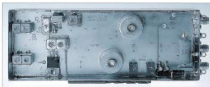
**Der als Fertigmodul sowie im Bausatz lieferbare DB6NT-Transverter hat ein Rauschmaß von 1,2 dB und gibt eine Sendeleistung von 200 mW ab – bei Abmessungen von 150 × 60 × 30 mm<sup>3</sup>.**
