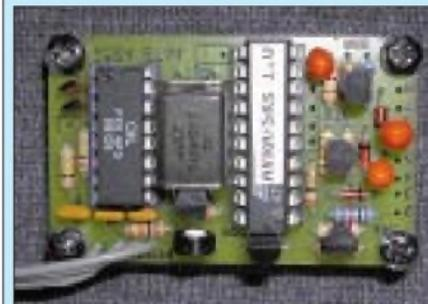
Das 1k2-PR-Modem AS52 ist recht kompakt aufgebaut. Vermutlich wird es, wie AS96, vorwiegend bei Bastelaktionen in den Ortsverbänden aufgebaut werden.
