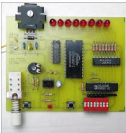
Das programmierbare Lauflicht ist eine Schaltung mit einer sehr ausführlichen Schaltungs- und Funktionsbeschreibung, die sich deshalb in besonderer Weise für die Ausbildungsarbeit eignet.
