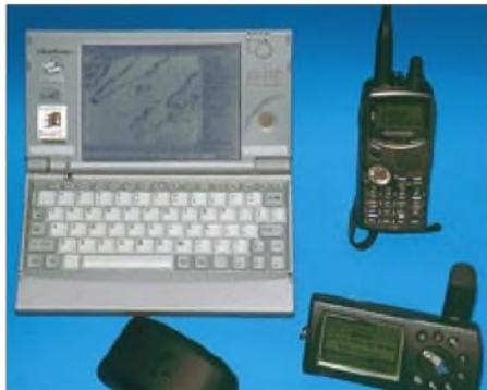
**Bild 3: Mögliche Konfiguration für eine APRS-Anwendung mit Plamtop, GPS-Handy und dem Duoband-Handy TH-D7E nebst integriertem TNC.** Fotos: DK2WV (2)
