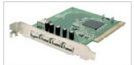
**Mit der USB-2.0-PCI-Karte von IOGEAR stehen fünf Ports der neuen USB-Generation für den PC- oder Mac-Einsatz bereit.**
