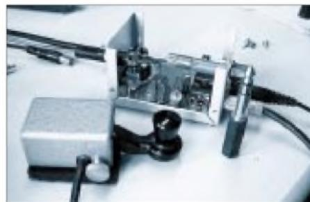
**Bild 19: Ein Mini-Direktmisch-Transceiver aus dem QRP-Report 1/2001 Foto: DL2FI**
