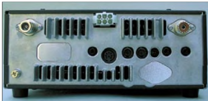
Jede Menge Anschlüsse bietet die Rückseite, die Antennenbuchsen sind verwechslungssicher in N- bzw. PL-Norm ausgelegt.
