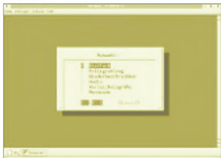
Bild 2: Die Auswahl der „Brenn-Optionen“ erfolgt menügesteuert mit Hilfe des Scripts „bmenu“ (siehe Listing).
