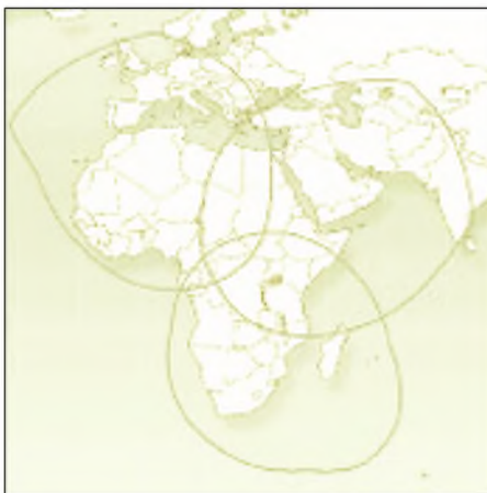
Ausleuchtzonen von Afristar des WorldSpace-Systems. Die „Abkappungen“ der Footprints entsprechen dem Satellitenhorizont, für die dahinter liegenden Gebiete ist der jeweilige Satellit nicht sichtbar. Der nordwestliche Beam ist auch in Europa zu empfangen.
