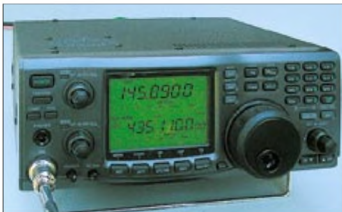
Frontansicht des IC-910H. Neben der Mikrofonbuchse sind zwei kleine Achsen zur Einstellung von Mikrofonverstärkung und Sendeleistung zu erkennen.
