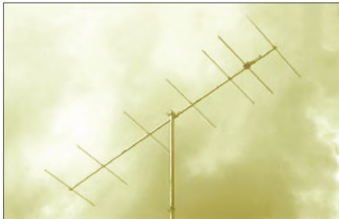
Bild 1: Ansicht einer von DK7ZB entworfenen [5] und aufgebauten 7-Element-Kurzyagi
