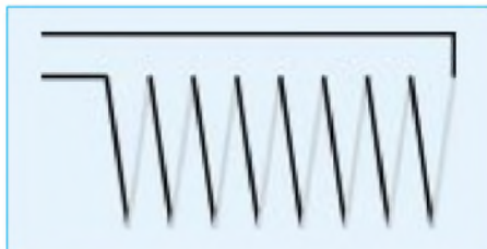
Bild 2: Mehrere Elemente können in Reihe geschaltet werden.
