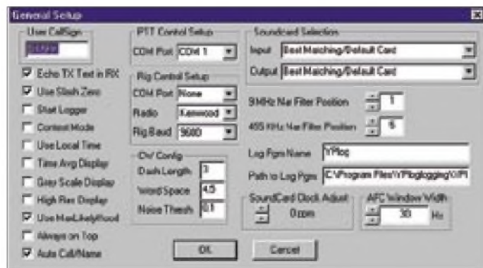
Bild 3: Setup-Fenster von HamScope. Nach dem Eintragen des eigenen Rufzeichens und dem Port für die PTT-Steuerung ist das Programm mit den Standard- einstellungen lauffähig.
