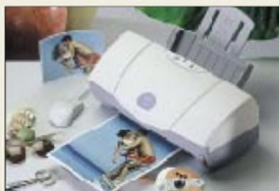
Mit dem S400 kann außerdem gescannt werden. Der Druckkopf wird dazu gegen den optional erhältlichen Farb-Scankopf IS-32 ausgetauscht. Der S400 läßt sich sowohl am Windows-PC (ab Version 95) als auch an allen Apple-Macintosh-Systemen mit USB-Schnittstelle einsetzen. Unverbindliche Preisempfehlung: 249 DM.
