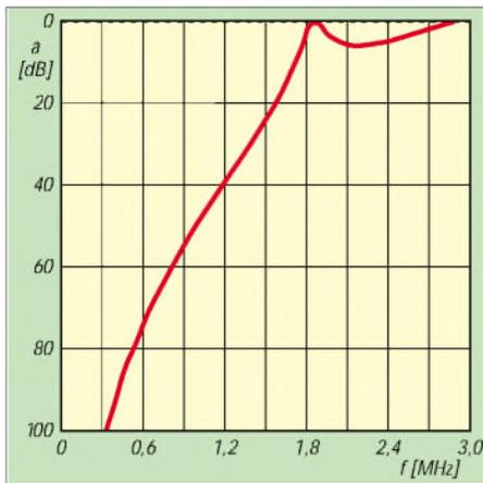
Bild 4: Durchlaßkurve des Hochpasses für das 160-m-Band
