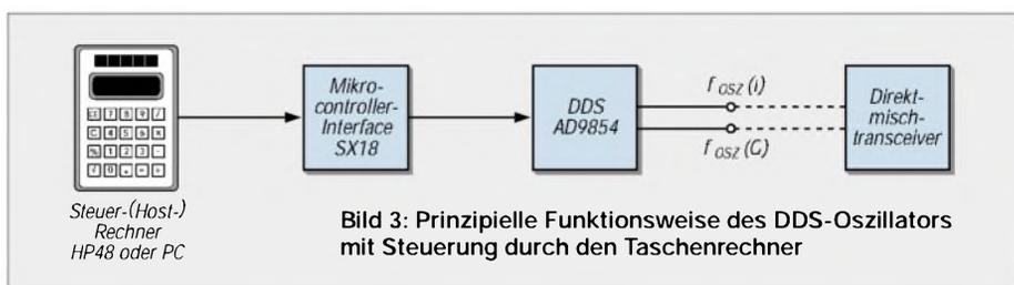
Bild 3: Prinzipielle Funktionsweise des DDS-Oszillators mit Steuerung durch den Taschenrechner
