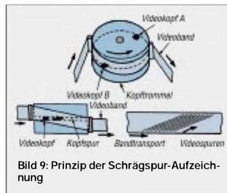
Bild 9: Prinzip der Schrägspur-Aufzeichnung
