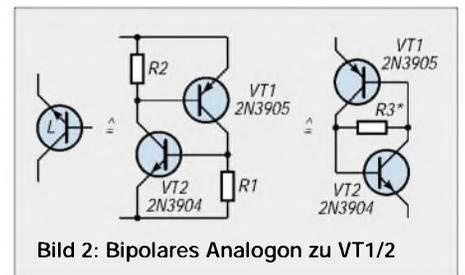
Bild 2: Bipolares Analogon zu VT1/2
