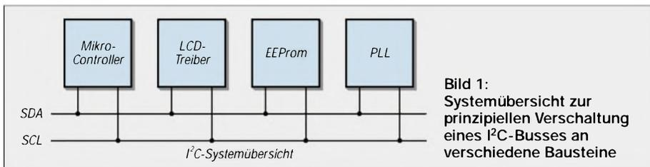
Nicht zu vergessen sei auch, daß ein solches System ohne externen Datenbus eine wesentlich geringere Störstrahlung in seiner Umgebung verbreitet. Ein großer Vorteil ist natürlich noch beim Aufbau von Prototypen die relativ geringe Anzahl der notwendigen Verbindungsleitungen, gerade, wenn der Prototyp freifliegend verdrahtet oder in Fädeltchnik aufgebaut wird.
