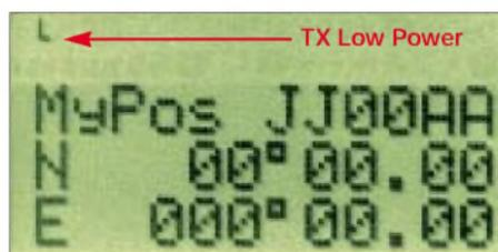
Bild 7: Positionsanzeige auf dem TH-D7E ohne angeschlossenen GPS-Empfänger
