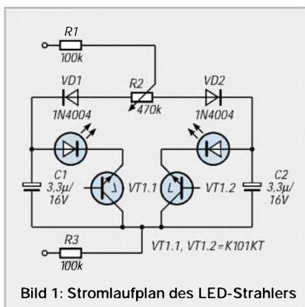
Bild 1: Stromlaufplan des LED-Strahlers
