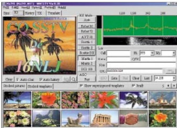
Bild 1: Hauptbildschirm von MMSSTV mit einem CQ-Ruf von 16N1J und zwölf (sichtbaren) TX-Bildern. Unter der Menüzeile befinden sich die Karteikarten *Sync*, *RX*, *History*, *TX* und *Template*. In der Mitte liegen die Tastfelder für den RX- bzw. TX-Mode, daneben sind Pegelanzeige (grüner RX-Balken) sowie Spektrum- und Wasserfallfenster zu sehen, darunter liegt das Logbuch-Feld.
