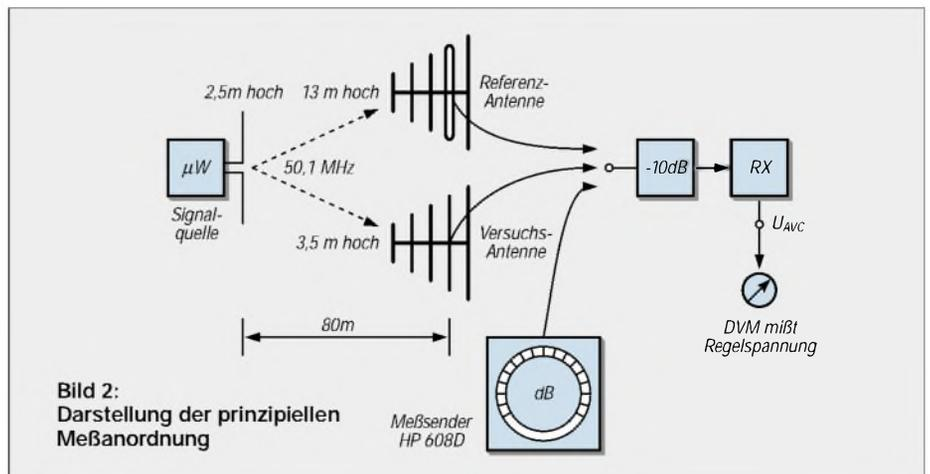
Bild 2: Darstellung der prinzipiellen Meßanordnung
