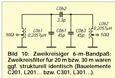
Bild 10: Zweikreisiger 6-m-Bandpaß; Zweikreisfilter für 20 m bzw. 30 m wären ggf. strukturell identisch (Bauelemente C201, L201... bzw. C301, L301...).
