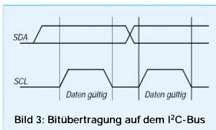
Nachdem ein komplettes Byte vom Master übertragen wurde, gibt dieser die Datenleitung SDA wieder frei (logisch High) und sendet zu den für die Übertragung eines Byte notwendigen acht Clockimpulsen einen weiteren neunten Clockimpuls. Der Empfänger muß während dieses neunten Impulses unter Beachtung der Setup- und Hold-Zeiten gemäß Spezifikation die Datenleitung SDA auf Low-Pegel.
