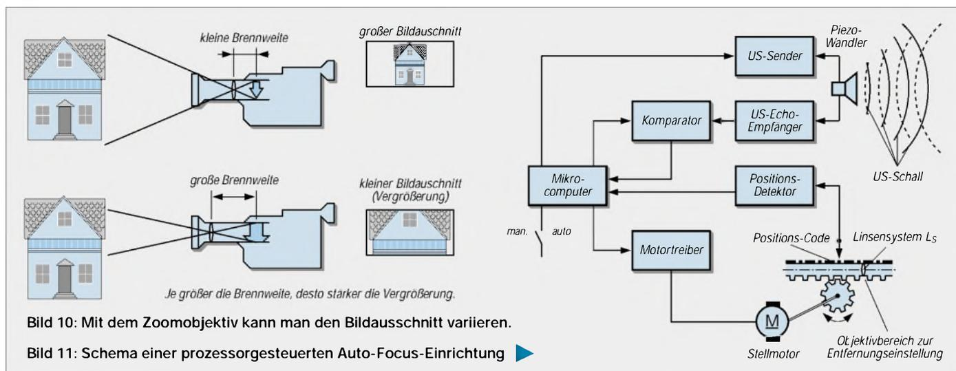
Bild 10: Mit dem Zoomobjektiv kann man den Bildausschnitt variieren.
