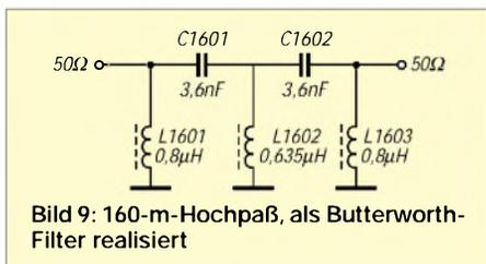
Bild 9: 160-m-Hochpaß, als Butterworth-Filter realisiert
