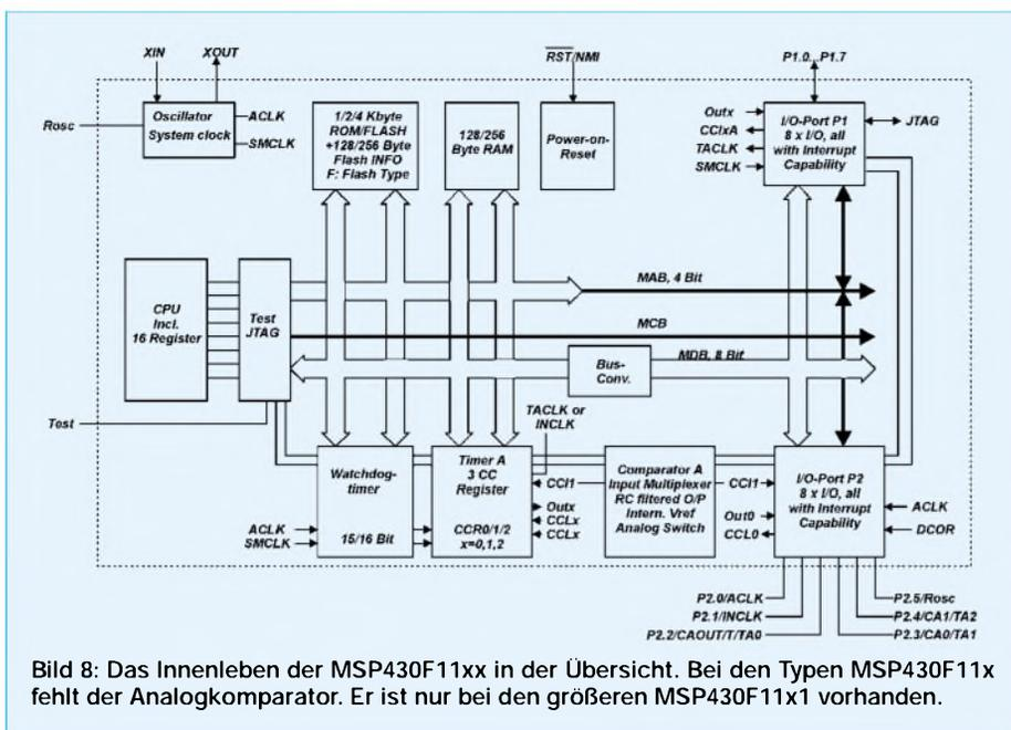
Bild 8: Das Innenleben der MSP430F11xx in der Übersicht. Bei den Typen MSP430F11x fehlt der Analogkomparator. Er ist nur bei den größeren MSP430F11x1 vorhanden.
