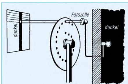
Bild 2: So begann es: Die Nipkow-Scheibe tastet die Bildvorlage zeilenweise ab, eine Fotozelle setzt die Hell-Dunkel-Werte in elektrische Impulse um.
