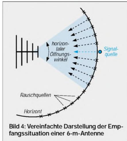
Diese theoretischen Überlegungen haben sich leider in einer Vielzahl von Versuchen bestätigt, die mit schwachen Signalen gemacht wurden. Messungen (entsprechend Bild 1) und auch Abhören zeigten deutlich, daß das Signal-Rausch-Verhältnis bei der oberen, bei der unteren Antenne wie auch bei beiden zusammen immer gleich ist – lediglich die Lautstärke ändert sich.
