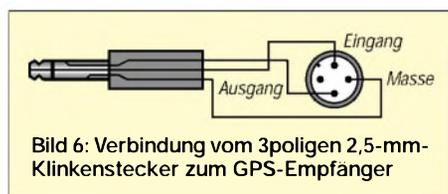
Bild 6: Verbindung vom 3poligen 2,5-mm-Klinkenstecker zum GPS-Empfänger
