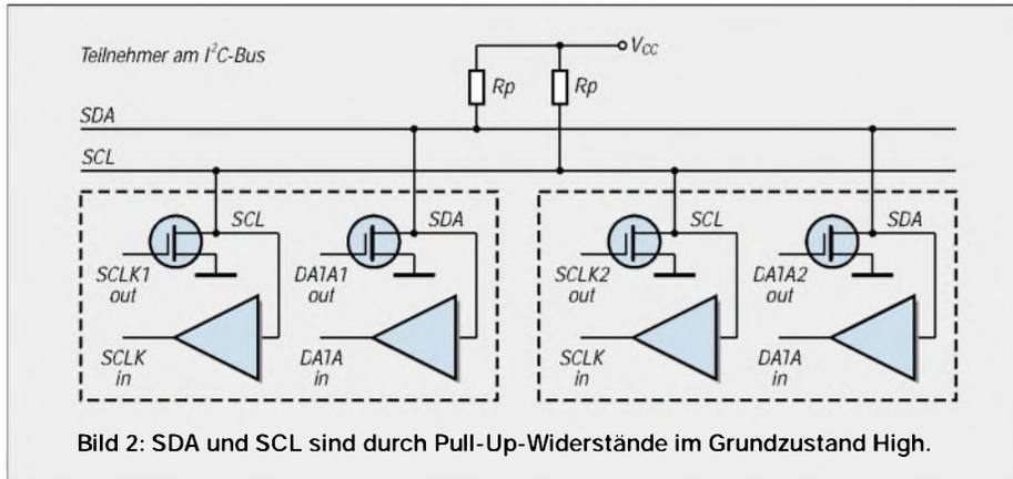
Start- und Stopbedingung werden immer vom Master generiert. Nach einer Startbedingung befindet sich der Bus praktisch in einem Busy-Zustand, kein anderer Teilnehmer darf ab diesem Zeitpunkt eine Start- oder Stopbedingung ausgeben. Erst nach einer erfolgten Stopbedingung ist der Bus wieder für andere Teilnehmer verfügbar. Nach einer Stopbedingung befindet sich der I<sup>2</sup>C-Bus wieder im Idle-Mode (Ruhezustand).
