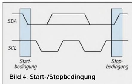
Es liegt nun an der Software des Masters, zu entscheiden, wie lange auf diesen Zustand gewartet (Timeout-Überwachung) und wie weiter verfahren werden soll, wenn das ACKNOWLEDGE vom Empfänger nicht ausgegeben wird. Erkennt der Master eine fehlerhafte Übertragung, so wird er die Übertragung mit einer Stopbedingung abbrechen und damit den I<sup>2</sup>C-Bus wieder freigeben.
