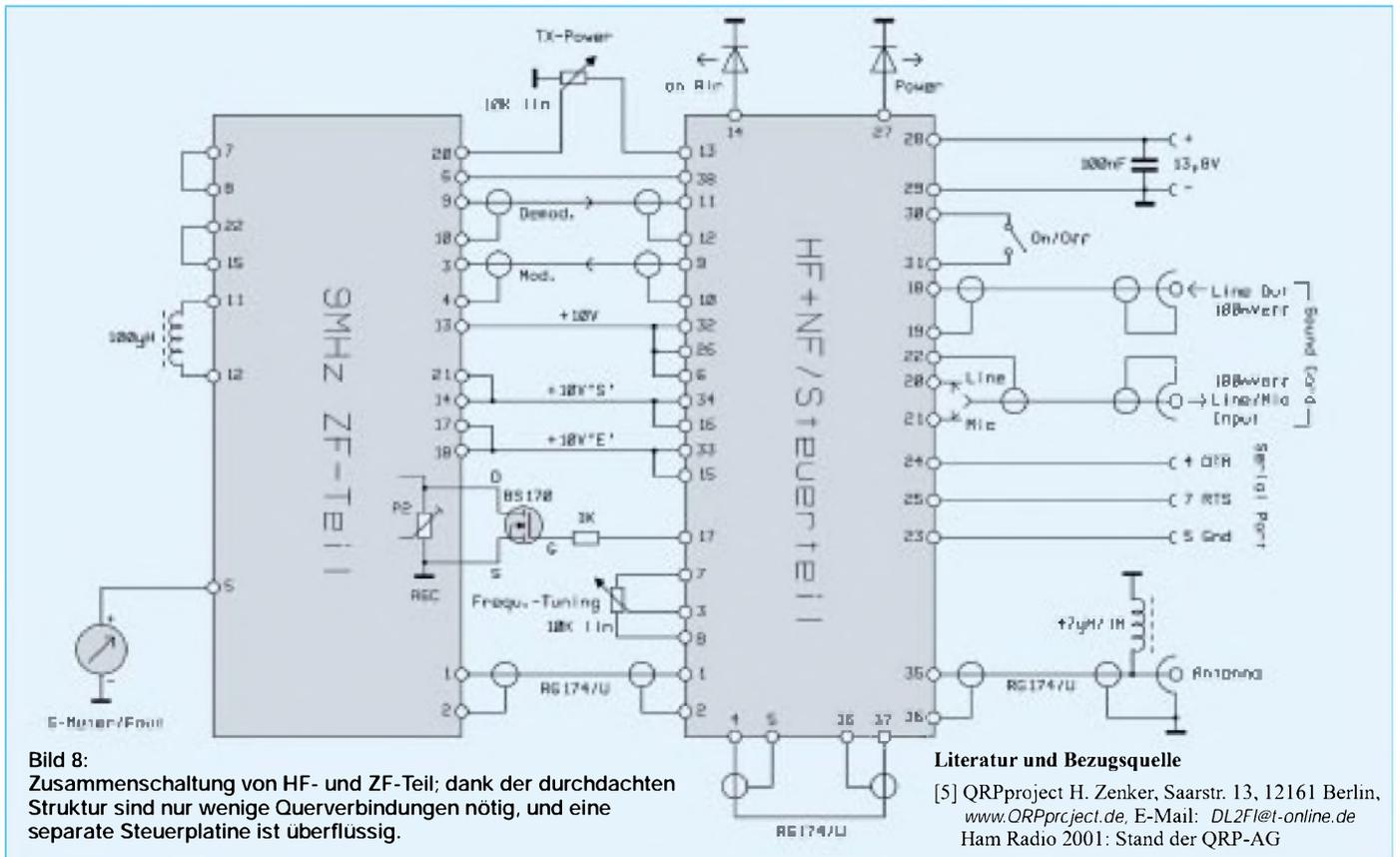
Bild 8: Zusammenschaltung von HF- und ZF-Teil; dank der durchdachten Struktur sind nur wenige Querverbindungen nötig, und eine separate Steuerplatine ist überflüssig.
