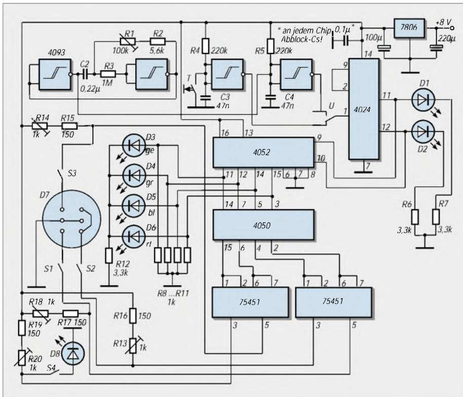
**Bild 3:** Das Schaltbild läßt die einzelnen Funktionsblocks erkennen.
