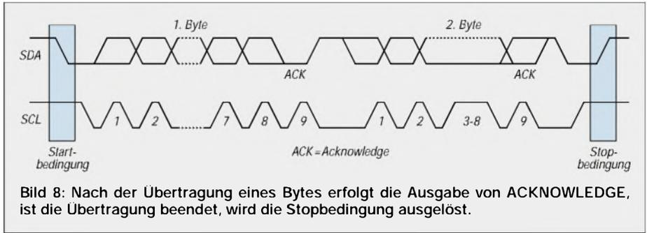
Bild 8: Nach der Übertragung eines Bytes erfolgt die Ausgabe von ACKNOWLEDGE, ist die Übertragung beendet, wird die Stopbedingung ausgelöst.
