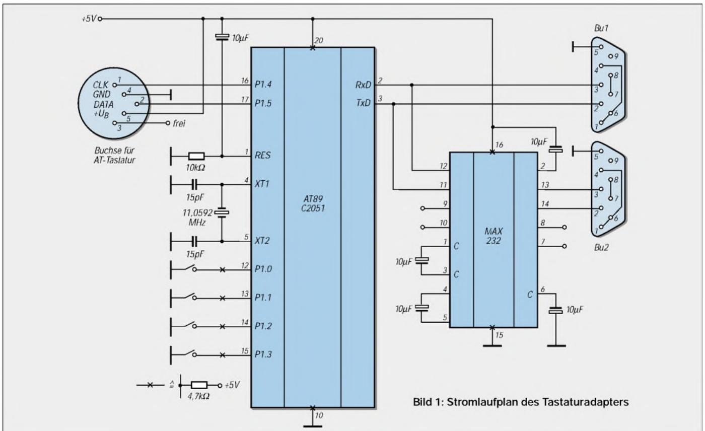
Bild 1: Stromlaufplan des Tastaturadapters
