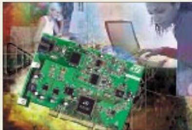
Als erstes Produkt seiner Art basiert der Chipsatz auf einem controllerlosen Design mit einem USB- oder PCI-Interface. Neben einer Verringerung des Kostenaufwands, des Platzbedarfs und der Leistungsaufnahme führt dies zu der Möglichkeit, die Produktlebensdauer durch einfache Firmware-Updates zu verlängern.
