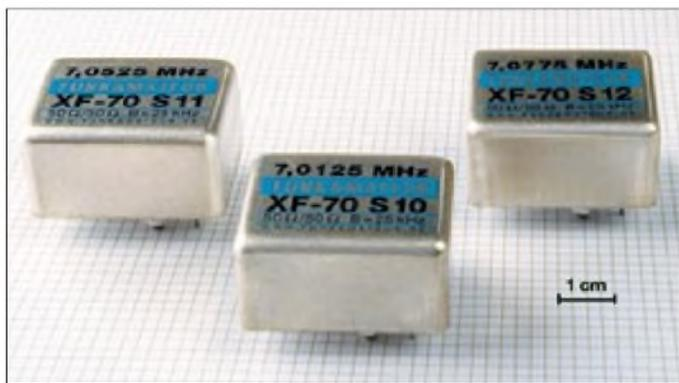
Bild 2: Frontend-Quarzfilter für verschiedene Bandsegmente zur steilflankigen Vorselektion auf dem 40-m-Band
