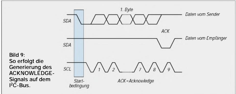
Bild 9: So erfolgt die Generierung des ACKNOWLEDGE-Signals auf dem I<sup>2</sup>C-Bus.
