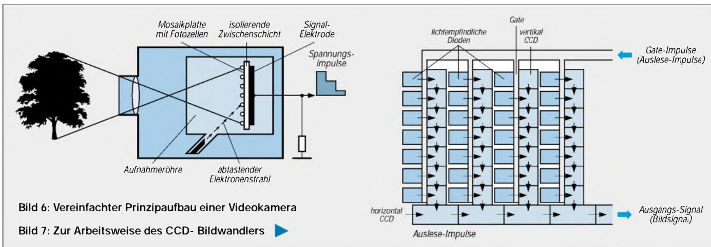
Bild 6: Vereinfachter Prinzipaufbau einer Videokamera
