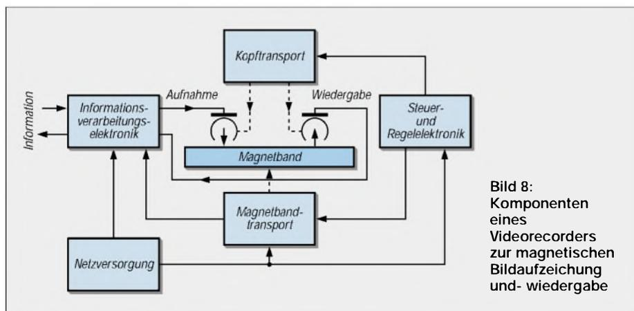
Bild 8: Komponenten eines Videorecorders zur magnetischen Bildaufzeichnung und -wiedergabe
