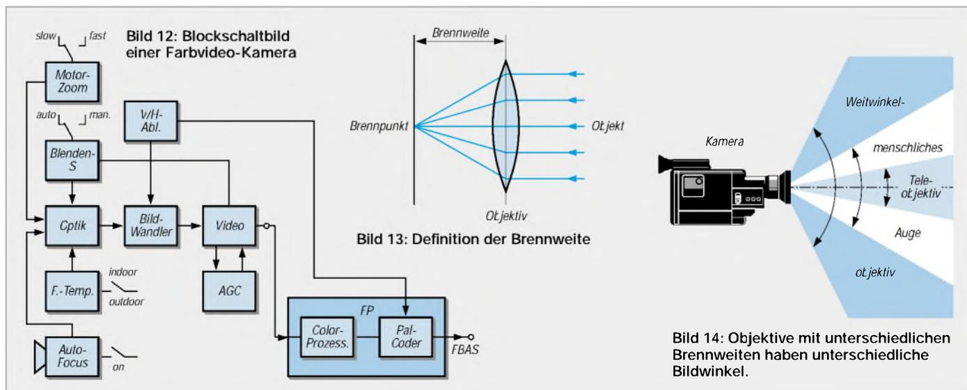
Bild 12: Blockschaltbild einer Farbvideo-Kamera
