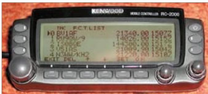
Das Bedienteil mit dem wahlweise hinterleuchteten Display ist vorrangig für Mobil- und weniger für Stationsbetrieb gedacht. Gleichwohl ist Zugriff auf alle Transceiverfunktionen möglich, wie hier z.B. auf die P.C.T.-Liste.
