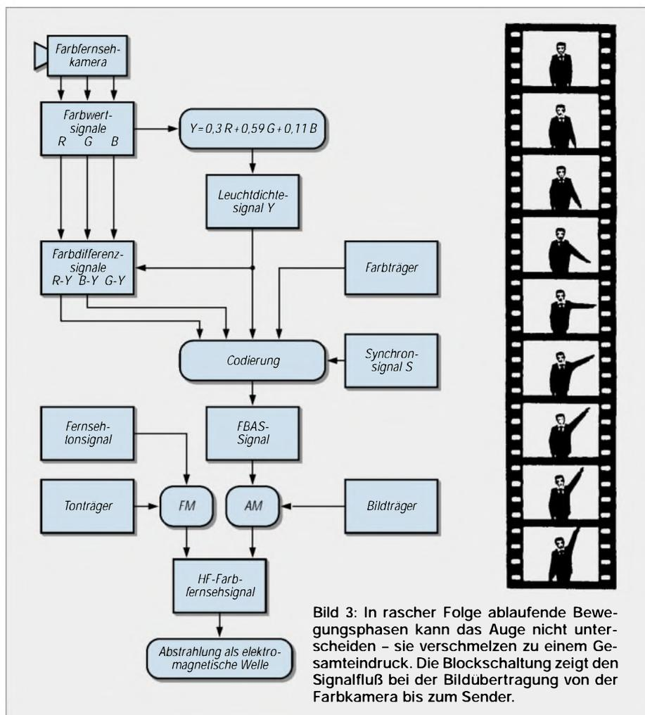
Bild 3: In rascher Folge ablaufende Bewegungsphasen kann das Auge nicht unterscheiden – sie verschmelzen zu einem Gesamteindruck. Die Blockschaltung zeigt den Signalfluß bei der Bildübertragung von der Farbkamera bis zum Sender.
