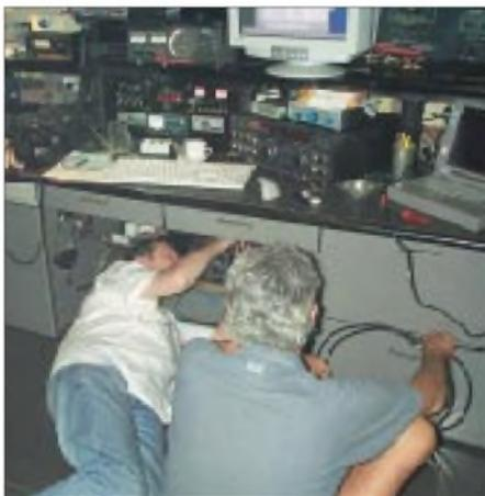
Auch das ist Contest. Reparatur der Dune-starfilter unter dem Stationstisch. Sie haben den RTTY-Dauerbetrieb nicht durchgehalten und wurden später durch Eigenbaufilter ersetzt.
