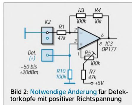
Bild 2: Notwendige Änderung für Detektorköpfe mit positiver Richtspannung
