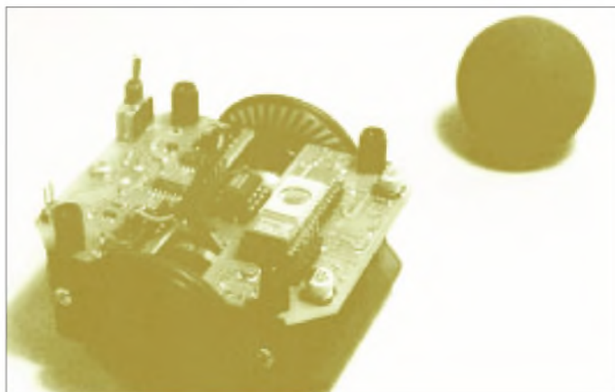
Bild 10: Fußballroboter „SEPPEL“ mit dynamischer Drehzählerfassung über Motor-EMK
