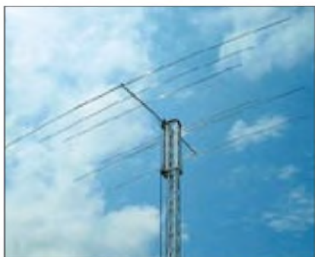
7-Element-Fünfbandbeam von Titanex mit neu entwickeltem Multiresonant-Open-Sleeve-Strahlersystem
