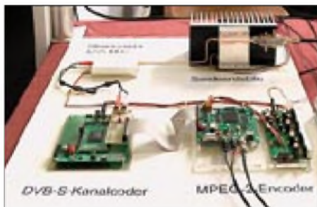
Sender für Digital-ATV, gemeinsam von DF9IC, HB9JNX, DL8SDL und DG8FAC entwickelt; Details unter www.D-ATV.de
