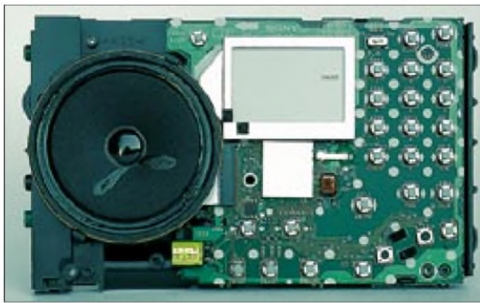
Der nackte ICF-SW7600GR zeigt einen sauberen Aufbau des Doppelsupers auf engstem Raum. Auch sämtliche Regler und der eingebaute Lautsprecher sind fest mit der Hauptplatte verbunden.
