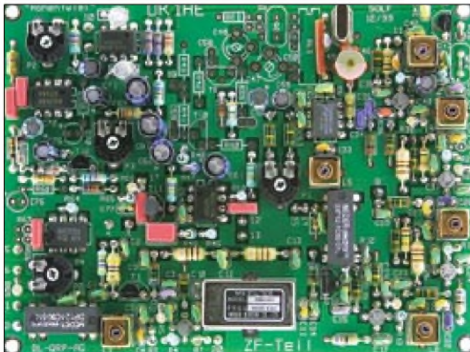
Bild 11: Gesamtansicht der ZF-Platine; am unteren Platinenrand etwa in der Mitte befindet sich das Quarzfilter. Die ganze Reihe von Bauelementen, die für SSB-Betrieb erforderlich sind, entfällt bei der PSK31-Anwendung.
