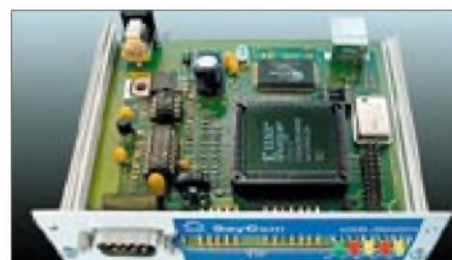
Dank Flexnet32-Treibern für Windows (≥ 98)-Betrieb gerüstet: USB-Packet-Radio-Modem für 1k2 bis 307 kBit/s von Baycom
