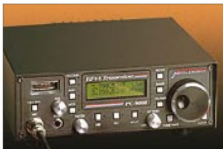
Für Patcomms Zweiband-QRP-Transceiver PC-9000 gibt es Bandmoduln von 160 bis 6 m.
