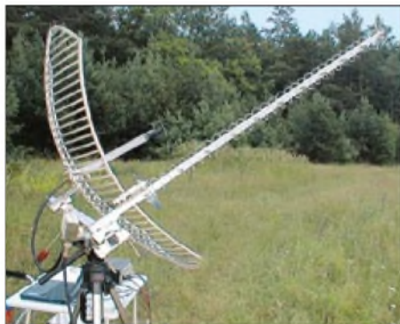
Bild 9: Typische S-Band-Antennen: BBQ-Spiegel und Helix mit 30 Windungen
