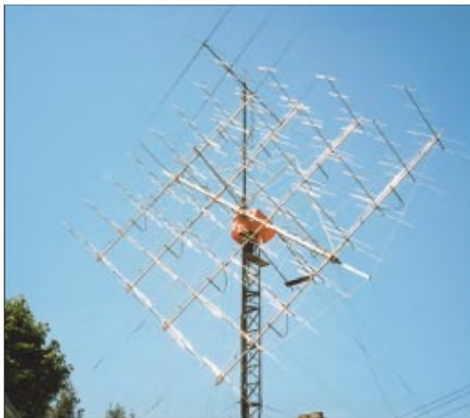
Bild 2: Diese aus 32 kurzen Yagis bestehende Antennengruppe von VE7BQH erlaubt eine zusätzliche Polarisations- drehung, hier im Bild sind es 40°.
