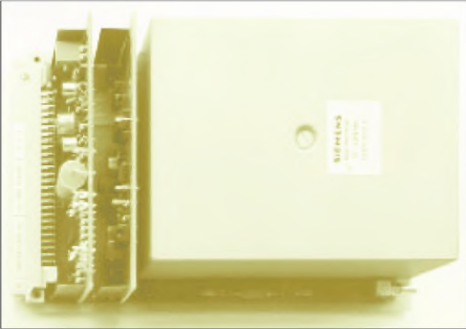
Bild 1: Der kommerzielle OCXO für 2,048 MHz
