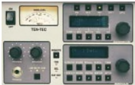
Detail mit „Auxiliary Parameters Group“, Speicher- und Scan-Einstellungen. Hier werden über Menü verschiedene Empfangseigenschaften festgelegt. Fotos: Chr. Ratzer
