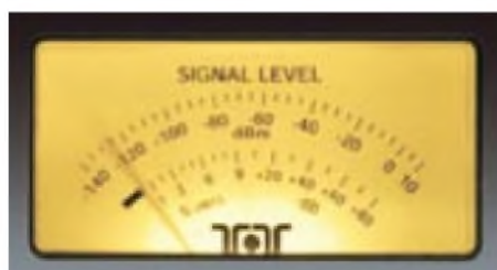
Das gut ablesbare in S-Stufen und dBm kalibrierte Anzeigeelement
