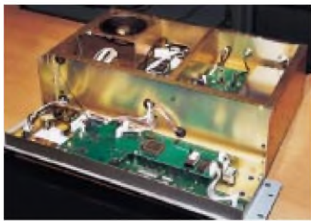
Gesamtansicht des geöffneten Empfängers mit heruntergeklappter Frontplatte
