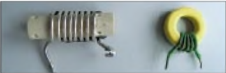
Bild 17: Zwei Spulen annähernd gleicher Induktivität von etwa 1 µH – die Luftspule links, aus 1,5 mm CuAg auf einen Keramikkörper gewickelt, hat bei 17 MHz eine Güte von 175; die rechte, mit CuLBW auf einen Amidonkern T68-6 gewickelt, bringt es auf 240 ... Foto: DL2RD
