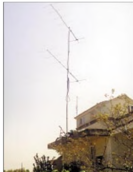
Der Mast mit den 2 x 9-Ele.-Yagis für 2 m fand in KM09 einen sicheren Aufbauplatz an der Hauswand
