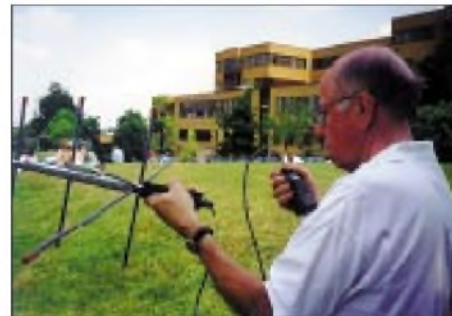
Ray, W2RS, zeigt, wie man mit einfacher Ausrüstung über AO-27 funkt: FT-50, 7- und 3-Ele.-Portabel-Yagis für 70 cm bzw. 2 m
