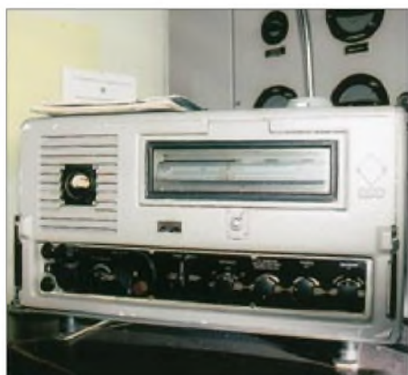
Schiffsempfänger „Dabendorf“, hier in der Version für den Empfangsbereich von 120 kHz bis 30 MHz
