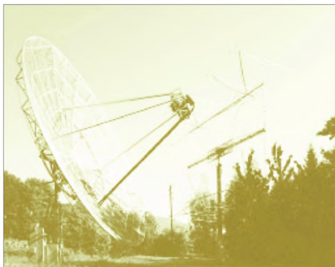
Bild 14: 8-m-Spiegel von HB9SV; als Erreger dienen ein zwischen 0° und 90° Polarisation drehbarer Dipol für 70 cm sowie ein zirkular polarisiertes Horn für 23 cm. Im Hintergrund ist eine 16er-Gruppe aus 17-Element-Yagis für 2 m zu erkennen.
