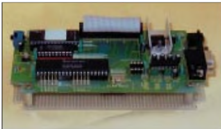
Bild 4: ELV-Prozessorplatine mit den Erweiterungen entsprechend Bild 5
