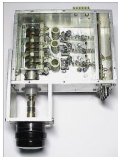
Bild 15: Mechanische Ausführung des beschriebenen VFO 40...70 MHz mit Drehkondensatorabstimmung und DAFC-Anschluß
