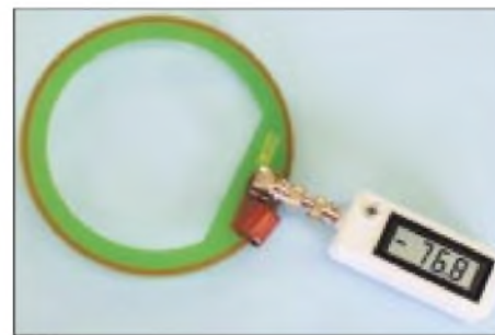
H-Feldsonde HFS1 in Verbindung mit Pegelmessgerät PWRM1 [10]... [12]
