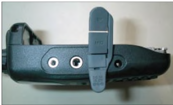
Die Buchsen des TH-F7E für Mikrofon und Ohrhörer bzw. TNC und PC-Programmierung werden je nach Anwendung intern umgeschaltet. Die Stromversorgung und Aufladung erfolgt über eine gängige Hohlstiftbuchse.
