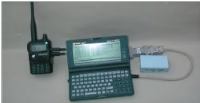
Packet-Radio portabel ist mit dem TH-F7E kein Problem. Man benötigt nur entsprechend handliche Modems oder TNCs und einen kleinen Computer. Scheinbar altmodische DOS-Palmtops, wie hier der HP-200LX, sind für PR immer noch die erste Wahl.
