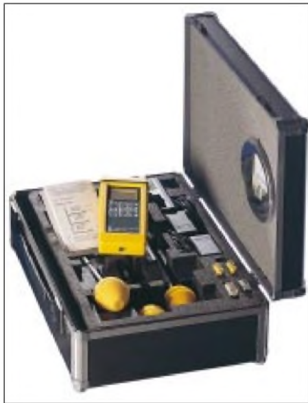
Kommerzieller Feldstärke-Meßkoffer von Wandel & Goltermann [12]
