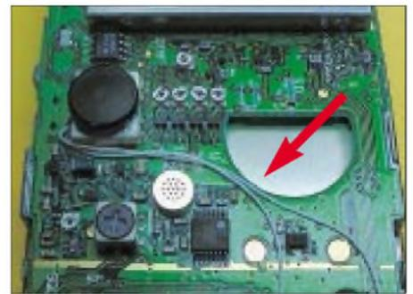
Bild 3: Kabelführung entlang des halbmondförmigen Lautsprecherausschnitts
