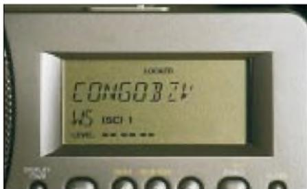
Die Ausrichtung der Antenne ist viel einfacher als bei herkömmlichen Rundfunksatelliten. Eine Balkenanzeige im unteren Bereich der LCD-Anzeige hilft bei der Optimierung der Empfangsrichtung.
