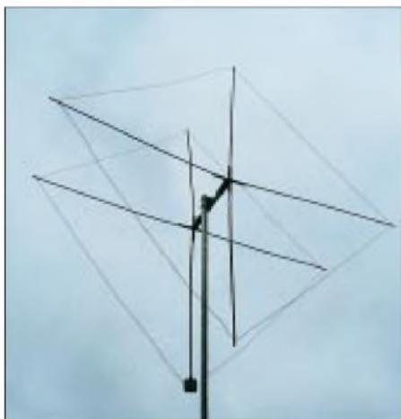
Bild 1: 2-Element-Quad für 6 m, in Diamond-Shape-Form
