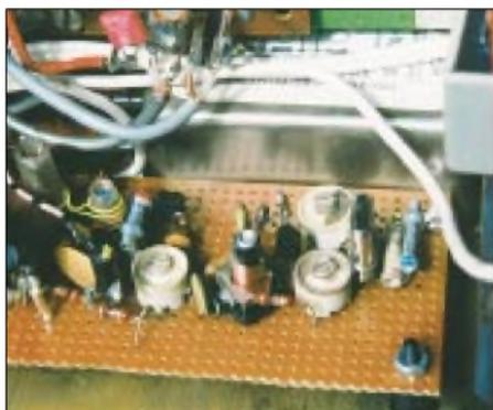
Bild 1: Teilansicht eines 2-m-Konverters – nicht verkaufswürdig, aber zweckmäßig!
