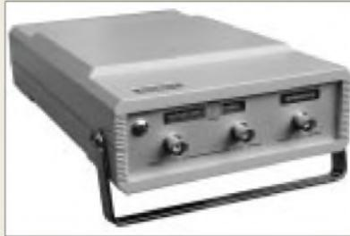
Es handelt sich um ein universelles Zweikanal-Meßgerät zum Anschluß an den Parallelport des PCs oder Notebooks. Mit Abtastraten von bis zu 50 MHz lassen sich bis zu zwei Signale im Zeit- und Frequenzbereich darstellen (einkanalig bis 100 MHz!).
