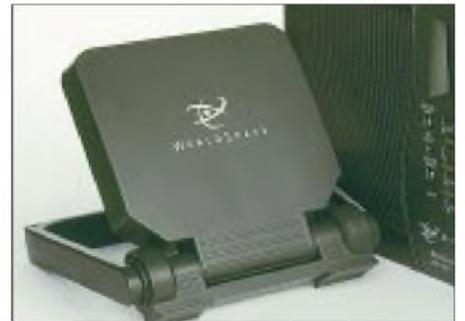
Die mitgelieferte Flachantenne läßt sich bei Bedarf abnehmen, um eine optimale Empfangsposition zum Satelliten einzunehmen.
