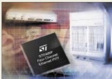
Der STE400P unterstützt den Voll- und Halbduplexbetrieb mit 100 MBit/s und 10 MBit/s. Neben der Autonegotiation-Funktion zur Erkennung von Übertragungsrate und Duplexbetrieb kann die Betriebsart auch manuell gewählt werden.
