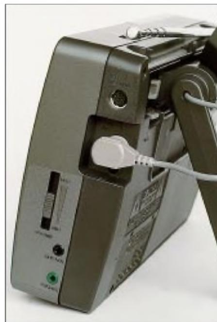
Die rechte Gehäusesseite des KH-WS1 bietet Anschlußmöglichkeiten für Kopfhörer, LINE, Datenkabel sowie Sat-Antenne in gängiger F-Norm. Fotos: hku
