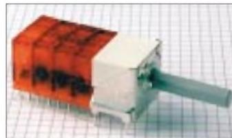
Bild 1: Baukastenprinzip macht die Schalter zu idealen Bauteilen für Amateure
