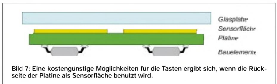
Bild 7: Eine kostengünstige Möglichkeiten für die Tasten ergibt sich, wenn die Rückseite der Platine als Sensorfläche benutzt wird.
