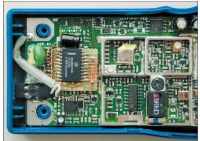
**Bild 6:** Derselbe Ausschnitt nach erfolgreicher Modifikation; unschwer ist die Reiterkarte mit dem neuen Mikrocontroller und den filigranen Drähtchen zur Hauptplatine zu erkennen.
