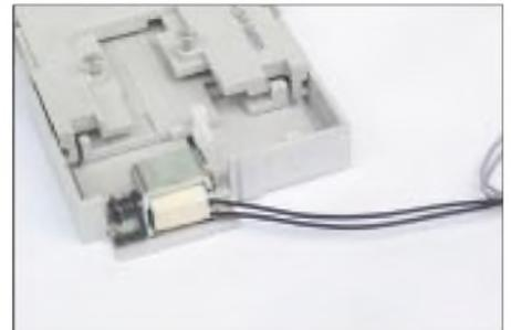
**Bild 5:** Beim Einschub der Chipkarte spannt sich eine Mechanik. Der Wiederauswurf der Karte erfolgt elektrisch über die Sperrenfreigabe durch einen Elektromagneten.
