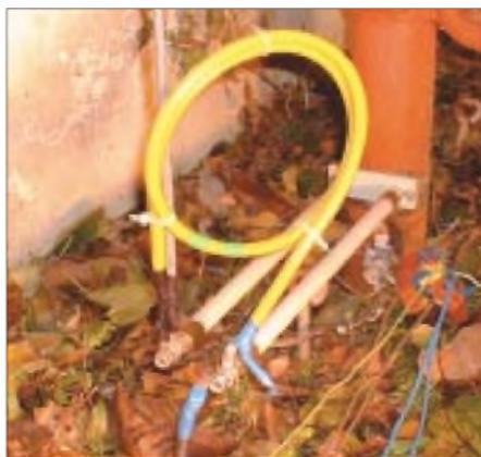
**Bild 3: Das Anpaßnetzwerk besteht aus RG-213-Koaxialkabelstücken. Fotos: DM3ML**
