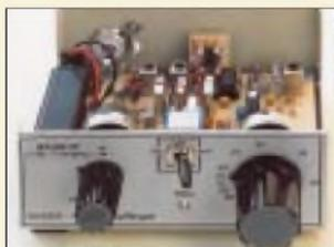
Dank vorliegender Platine und handelsüblichem Gehäuse ist der 40-m-Empfänger schnell aufgebaut. Foto: DK6SX
