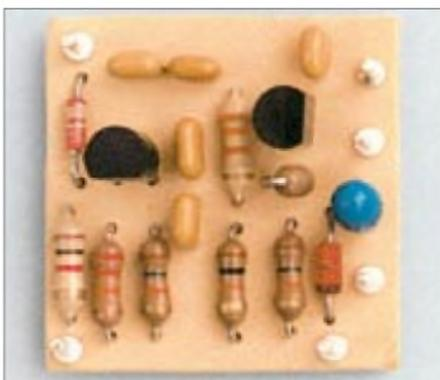
**Bild 10: Musteraufbau des Vorverstärkers**
