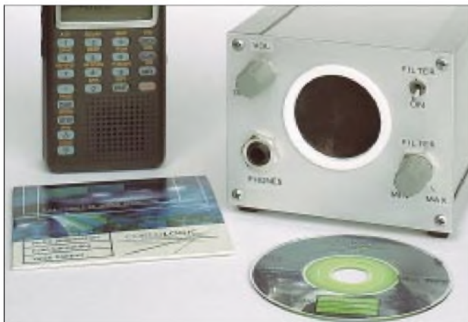
Ursprünglich für den Profibereich entwickelt, eignet sich das Cortologic-System auch gut für die Entfernung von Rauschen unter- und oberhalb von 30 MHz.
