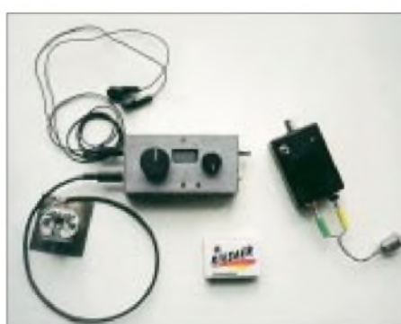
Bild 8: Minitransceiver mit eingebautem ZEM – das zur Anzeige dienende I 2 C-Display ist kaum größer als eine Armbanduhr. Rechts daneben ist der Antennentuner zu sehen.
