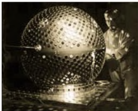
Der mit Spiegeln versehene Starshine-OSCAR 43 hat einen Bakensender auf 145,423 MHz.
