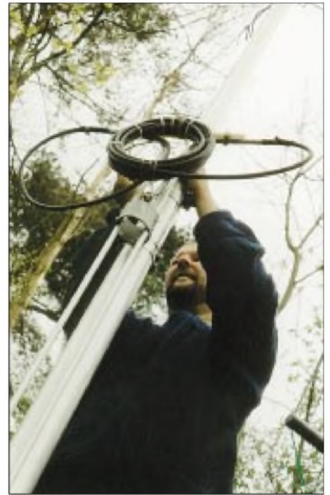
Bild 7: Verlängerungsspule aus Koaxialkabel; zum genaueren Abgleich der Mittenfrequenz ist eine Windung teilweise herausgezogen.
