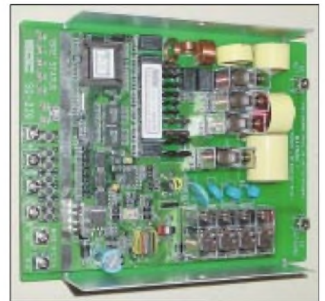
Bild 2: Blick auf die Platinenoberseite mit den HF- und Steuerungsbauteilen Fotos: DK7ZB
