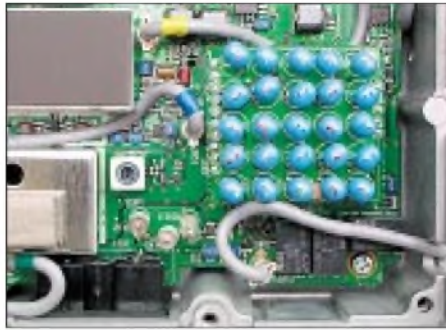
Bild 11: Diese „Bonbonschachtel“ wurde als Sub-Leiterplatte für die mit größeren Spulen aufgebauten Empfänger-Eingangsfiltre 1 bis 5 für 1,6 bis 8 MHz notwendig.
