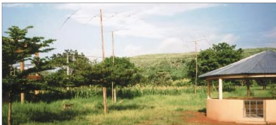
Blick auf die Antennenfarm und einen der Hügel des Umfelds. Vorn die 4-Ele.-Yagi für 10 m, dahinter die 5-Ele.-Yagi für 6 m und rechts die 3-Ele.-Dreibandquad für 10, 12 und 15 m
