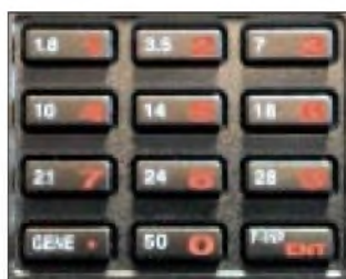
Bilder 12 und 13: Auch kleine Änderungen haben oft merklichen Nutzen: z.B. besser lesbare Ziffern am Frequenz-Direkt-eingabefeld (grün: PRO; rot PROII).
