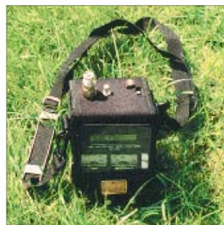
Bild 12: Zur Messung von Real- und Imaginärteil der Antennenimpedanz eignen sich aktive Stehwellenmeßgeräte, wie hier das MFJ-269. Foto: DL2RD
