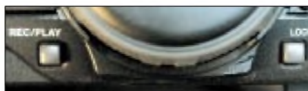
Bild 15: Links, hart unter dem Abstimmknopf bedient man den neuen Voice-Recorder für wichtige 15 s Funk-„Rückbesinnung“.
