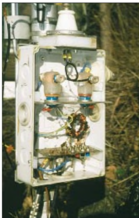
Bild 4: Blick in den Verteilerkasten mit dem Anpaßübertrager, darunter der Isolierfuß, dahinter das vom Isolierfuß verdeckte Standrohr; als Koaxialsteckverbinder nur N-Verbin-
