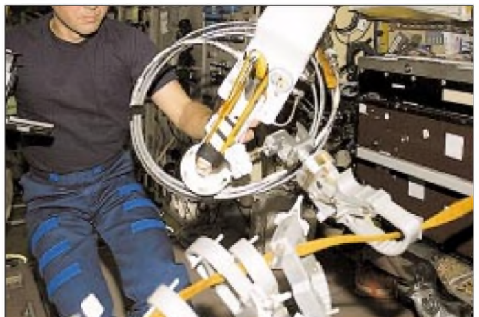
Die noch zusammenge- rollte Kurzwellen- antenne WA4 vor der Montage an der ISS Foto: ARISS
