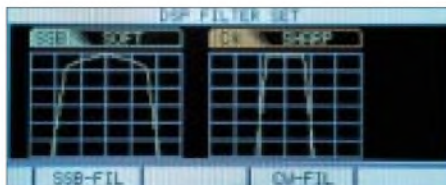
Bild 16: Um das Menü für die Umschaltung der neuen SSB- und CW-Softfilter zu erreichen, braucht es drei Tastendrucke.
