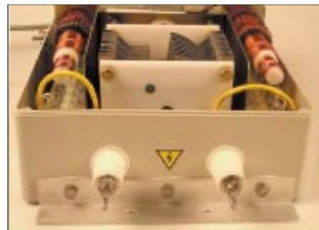
**Bild 7: An der Kopfseite des Tuners befinden sich zwei Flügelmuttern für den Anschluß einer symmetrischen Antenne bzw. Hühnerleiter.**
