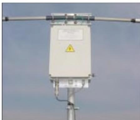
**Bild 4: AG-3 im Speisepunkt eines selbstgebauten Drehdipols mit 2 x 6,50 m Länge**
