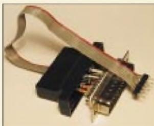
Das Programmiergerät kann „on the fly“ in einem SUB-D-Steckverbinder Aufnahme finden. Foto: DL7UNO
