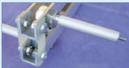
**Bild 7: Rückansicht der Portabelvariante mit Elementestummel für Teleskopstab**
