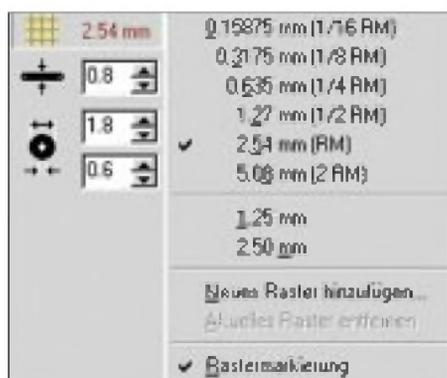
**Bild 3:** Wird das karierte Rastertastfeld angeklickt, erscheint ein Fenster zur Einstellung des Rasterabstandes in mm oder Zoll. Die Häkchen markieren den aktuellen Zustand.
