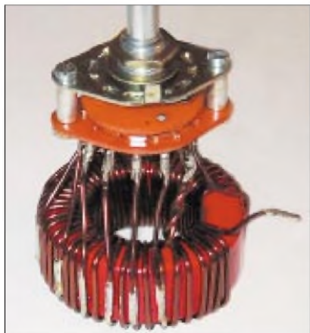
Bild 4: Stufenschalter und Schwingkreisspule fertig verdrahtet – die Koppelwicklung fädelt man erst im eingebauten Zustand durch. Die zweite Schalterebene wurde entfernt.
