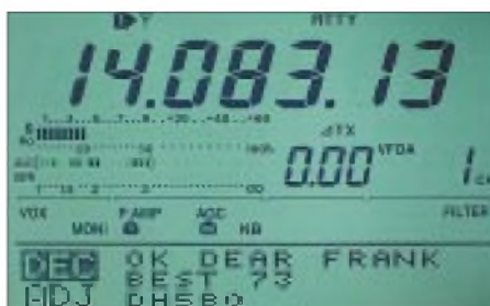
Das IC-746-like Display zeigt in seinem Punktmatrixteil doch ein paar zusätzliche Dinge, z.B. drei Zeilen dekodiertes RTTY-Signal.
