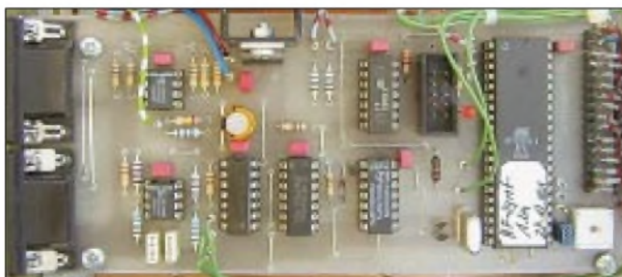
Bild 10: Der Aufbau der Steuerungsplatine erfolgt auf einer einseitig kaschierten Platine. Fotos: DH1AAD
