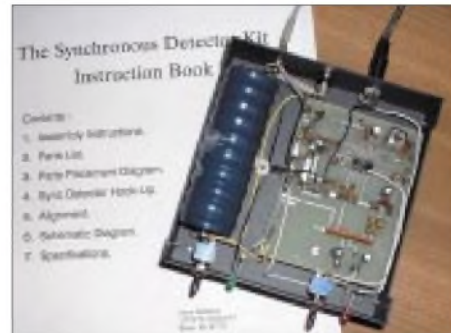
Bild 2: Die Bestückung aller Bauelemente erfolgt auf der Leiterseite. Fotos: Rehfeldt
