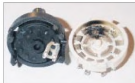
Bild 5: Infolge unzureichender Spannungsfestigkeit zerstörter Stufenschalter
