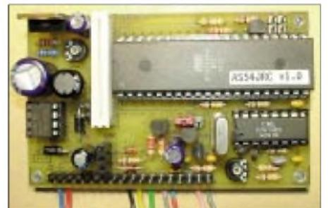
„AS54JRC“ besteht aus einem GPS-Empfangsmodul mit Stützbatterie und Antenne sowie einem vierzeiligen LC-Display. Durch das mikrocontrollergesteuerte Modul (Foto) erfolgt die Aussendung der jeweiligen Position im APRS-Format.
