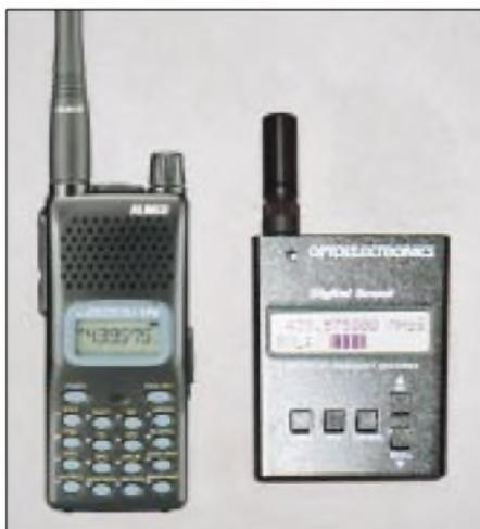
**Bild 1:** Der Scout zeigt die Sendefrequenz des „Digital Voice“-Signals anstandslos an.
