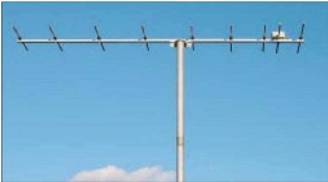
Bild 1: Die 9-Element-Yagi mit 1,50-m-Boom
