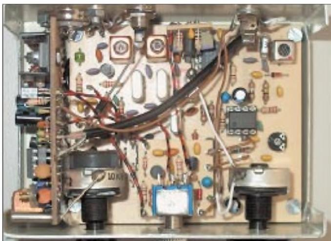
**Bild 3:** Innenansicht des fertig aufgebauten Gerätes; links ist stehend die Senderplatine angeordnet, unten in der Mitte befindet sich die Platine der Sende-Empfangs-Umschaltung, und oben in der Mitte ist, abermals stehend, die Platine des RX-Vorverstärkers zu erkennen.
