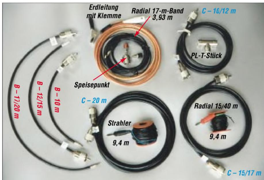
Bild 4: Der Antennen-Anpaßsatz, hier ohne die 7-m-Drähte; Bezeichnungen B und C korrespondierend mit Bild 2
