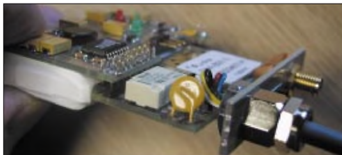
Bild 4: Doppelstöckiger Aufbau der GPS-RX Platinen
