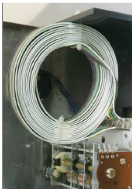
Bild 1: Spulen aus Flachbandkabel haben hohe Induktivitäten und sind freitragend.
