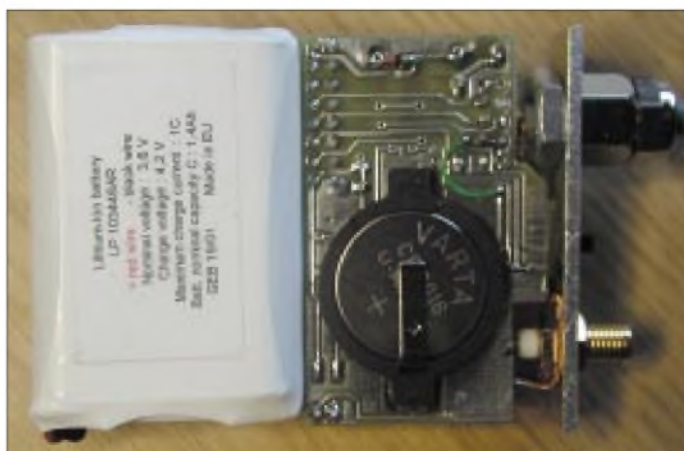
Bild 4: Doppelstöckiger Aufbau der GPS-RX Platinen
