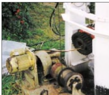
Bild 9: Die Antriebsmaschine zum „Herunterholen“ und zum „Umlegen“ der 4-El-Quad
