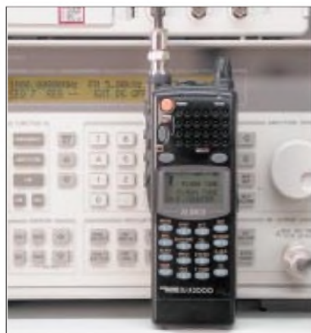
Bild 1: Die Empfindlichkeit des DJ-X2000E-Frequenzzählers wurde am Meßsender ermittelt. Foto: Eilenburg
