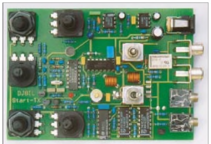
Bild 2: Betriebsfertig bestückte Platine; die Anordnung der Bauteile läßt dieselbe Gliederung erkennen wie im Stromlaufplan.
