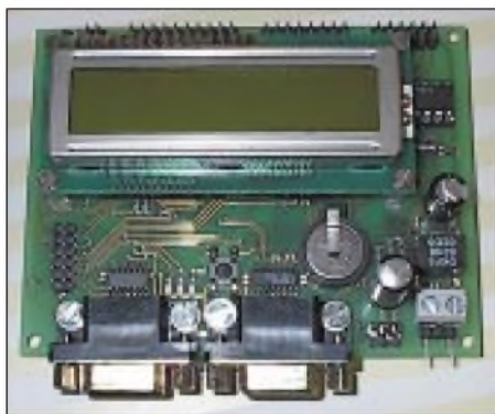
Bild 1: Fast vollständig in SMT aufgebaut: das MCS® 51-basierte Mikrocontroller-Board µAnt51
