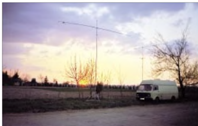
Die aufgebaute Station in KN49KA mit Sonnenuntergang in Richtung Deutschland; links die 17B2 für 2 m, rechts die 9-El.-Yagi für 2 m sowie die HB9CV für 6 m.
