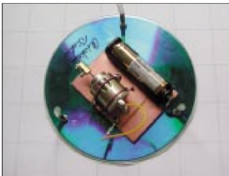
Die Kupferfläche der Grundplatine wird unsymmetrisch unterbrochen, damit die Teilflächen stets mit der Batterie verbunden bleiben können. Als Schaltersatz dient ein 1,3-mm-Stecker mit Steckschuh.
