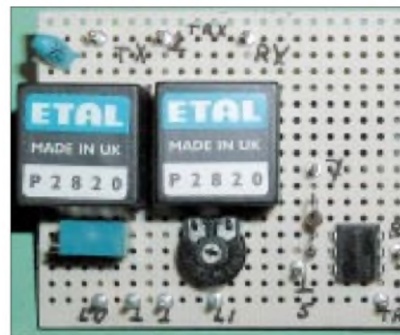
Bild 5: Die wenigen Bauelemente für das Soundkarteninterface sind auf einer Lochrasterplatine schnell untergebracht.
