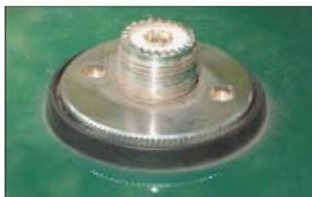
Durch den metallisch leitend auf dem Autodach angebrachten PL-Fuß stellt die Karosse ein gutes Gegengewicht dar. Fotos: -rd
