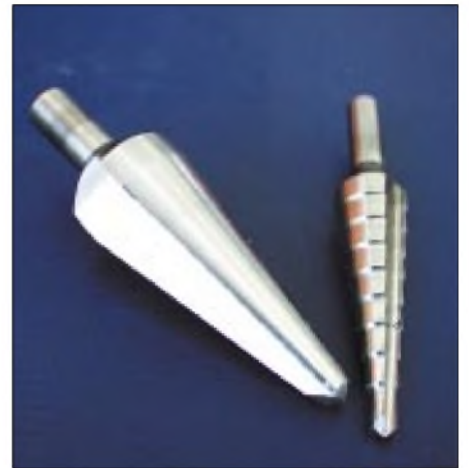
Bild 7: Schälbohrer zum Herstellen von sauberen Löchern in Dünnschichten
