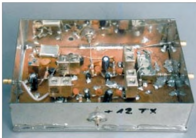
Bild 2: 70-cm-Transverter in stark vereinfachter... „SMD“-Technik. Eine ähnliche Bauweise wurde übrigens vor Jahren im FA schon einmal vorgestellt [2]. Fotos: DL7HG
