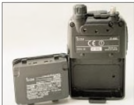
Der Lithium-Ionen-Akku benötigt trotz winzigster Abmessungen bereits einen großen Teil des Gerätevolumens.
