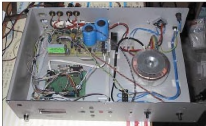
Bild 12: μAnt51 im Einsatz: Steuerung eines Eigenbau-UKW-FM-Tuners
