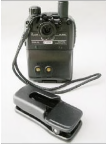
Der neuartige Clip wird am Gürtel eingehakt, am Gerät selbst verbleibt nur ein kleiner Knopf, mit dem es am Clip eingerastet werden kann.
