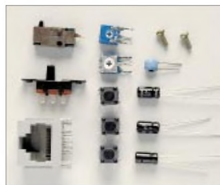
Bild 3: Außer der SMD-bestückten Platine enthält der Umbausatz noch diese Teile, die mit einem kleinen Löt-kolben selbst bestückt werden müssen.
