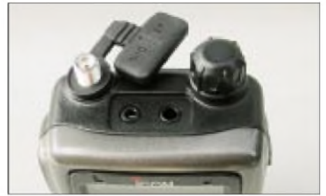
Auf der Oberseite gibt es neben dem Hauptabstimmknopf und der SMA-Antennenbuchse zwei Klinkenbuchsen als NF-Anschluß.
