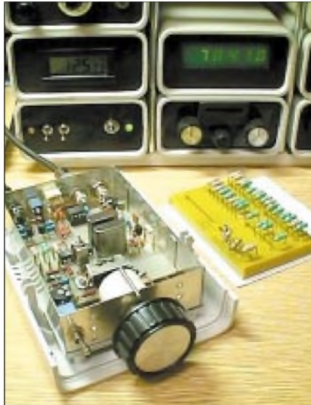
Bild 1: Experimentalaufbau des Quadro-Oszillators; rechts daneben eine Reihe von Spulen für die Suche nach einem optimalen Ziehbereich. Im Hintergrund einige Module des QRP-Transceiversystems.
