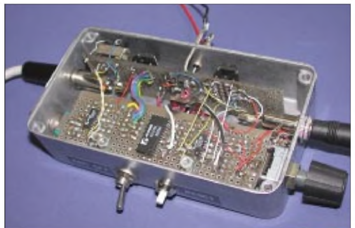
Bild 2: Experimentalaufbau des DSP-RX-Moduls mit zwei schaltbaren Filtern, abschaltbarer AGC und Paßband-Tuning
