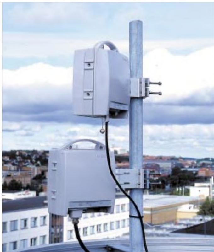
Eine einzige Send- und Empfangsanlage für Wireless Local Loop verursacht allein schon Kosten im sechstelligen Eurobereich. Im Bild der Router AXI 540 für drahtlose Ortsnetzanschlüsse
