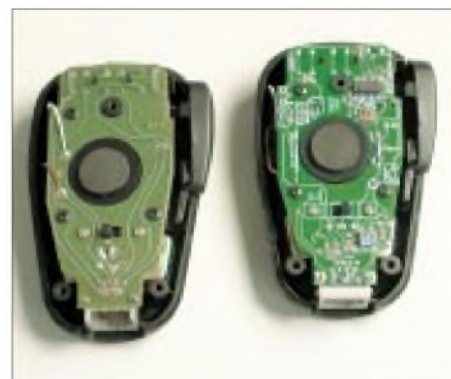
Bild 4: Innenansicht des Original-Yaesu-Mikrofons MH-31A8J (l.) und eines umgebauten Mikrofons (r.)
