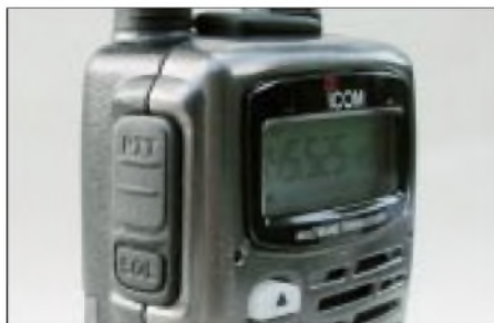
Unter der Sendetaste liegt auf der linken Seite noch die Taste zum Öffnen bzw. Einstellen der Rauschsperr.
