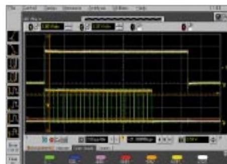
Bild 5: Ausgangssignal des DSP AL3101 (Eingang des DAC), jedoch ohne AGC, Empfänger voll aufgeregelt
