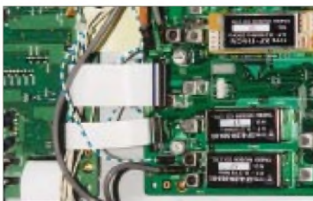
Bild 6: Gelöste Flachbandkabel an der IF-Platine Fotos: DL8LBK
