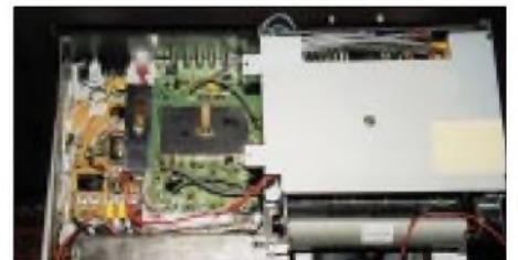
Bild 3: Das umgeklappte PA-Modul mit Sicht auf die RF-Platine (die grüne Platine in der Mitte)
