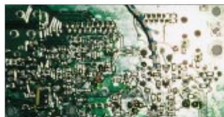
Bild 8: Anschlußpunkt C2148 auf der Unterseite der IF-Platine (gegenüber Bild 7 um 90° gedreht)
