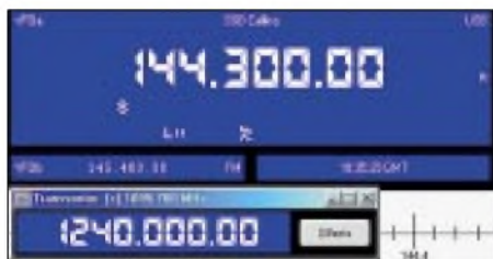
Bild 4: Das Transverter-Display stellt die tatsächliche Arbeitsfrequenz dar.
