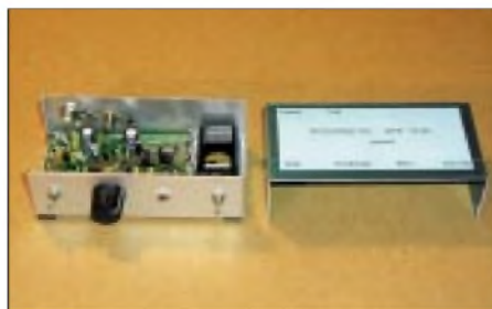
Dank einer mit Bestückungsaufdruck versehenen Platine läßt sich dieser Empfänger in kurzer Zeit aufbauen. Das hier vorgeschlagene Gehäuse nimmt die wenigen Bedienelemente auf, und der Aufbau bleibt somit übersichtlich.
