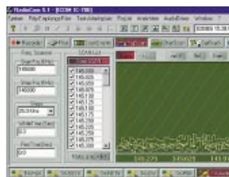
Bild 9: Durch die Kombination von Empfängerfernsteuerung und NF-Analyzer sind solche 3D-Darstellungen in frei wählbaren Frequenzfenstern möglich. Screenshots: DL3AYJ
