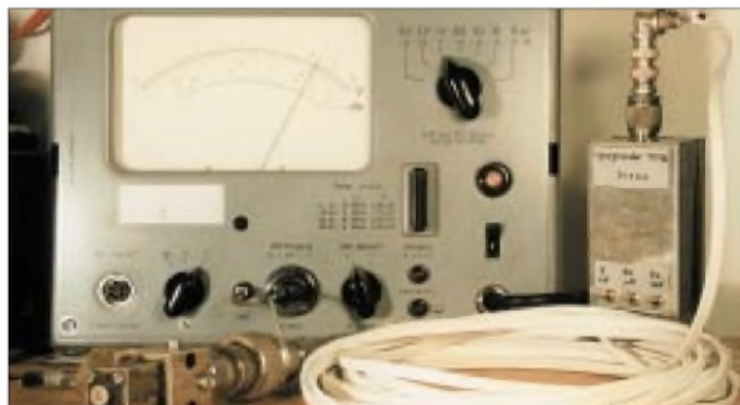
Bild 1: Man traut seinen Augen nicht: Simples Elektriker-kabel leitet HF bei 50 MHz! Foto: DL7HG
