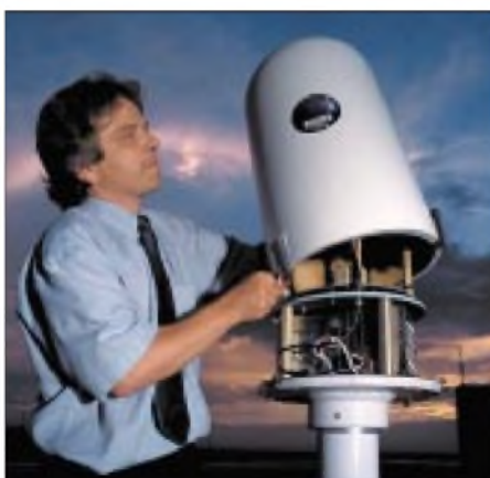
Bild 12: Wartung eines Impact-Sensor (Gewitterpeilantenne) des Blitz-Informations-Dienstes von Siemens Werkfoto
