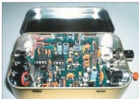
Bild 2: Musteraufbau des RockMite, untergebracht in einer Blechdose Foto: N0JRN
