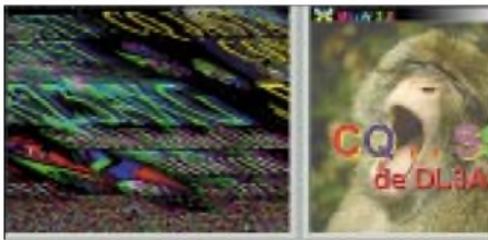
Bild 6: Links ein SSTV-Bild, das einer Schräglaufrückkorrektur (Slant) bedarf
