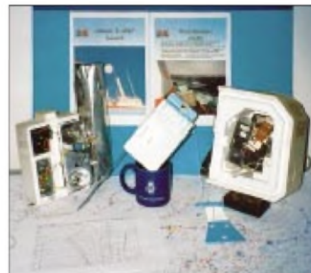
Radiosonden im Größenvergleich: gestern (links und rechts) – heute (Bildmitte). Fotos: DWD
