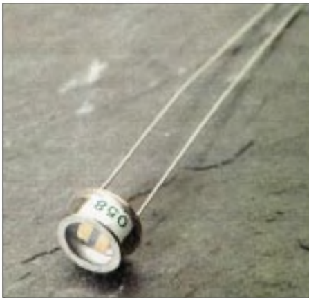
Bild 1: In diesem Projekt kam ein PbS-Detektor von Hamamatsu zum Einsatz.
