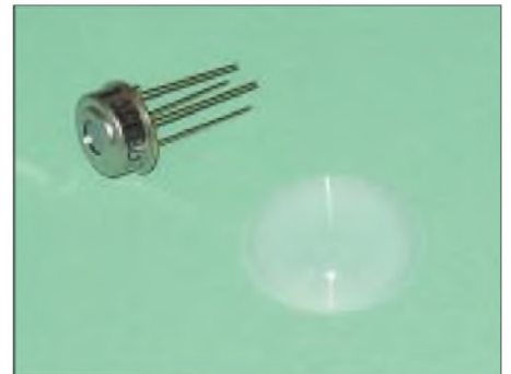
Bild 27: Eine Kunststoff-Fresnellinse ist kaum größer als ein Thermopile.
