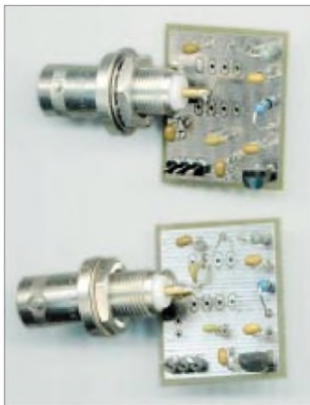
Bild 4: Linearer und logarithmischer Meßkopf. Bis auf die Meßdetektoren auf der Leiterseite sehen beide annähernd gleich aus.
