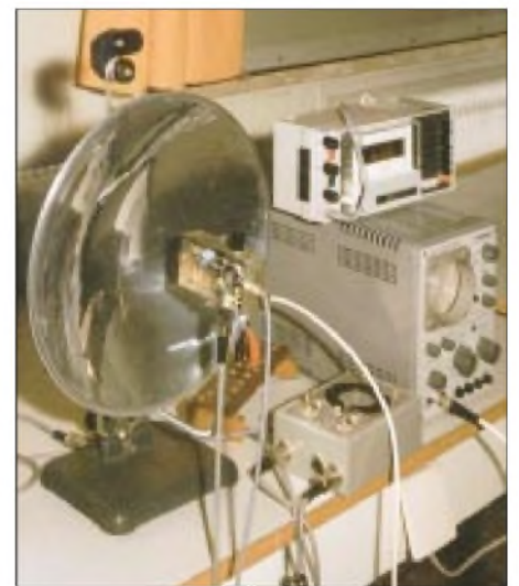
Bild 2: Versuchsanordnung eines Infrarot-Ortungsgeräts (Flammenmelder)
