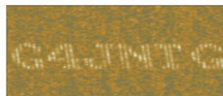
Typisches Bild einer Multiton-Hellschreibernausbildung mit einer Bandbreite von nur 10 Hz
