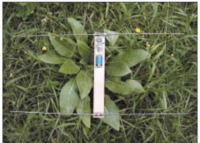
Bild 7: Gesamtansicht des Empfängers, hier als Laboraufbau, bei dem die Platine als Antennenträger dient Fotos: DL7UNO
