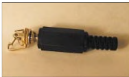
Bild 4: Die Kontakte an der Buchse dienen gleich mit zum Ein- und Ausschalten des Fuchsjagdempfängers.
