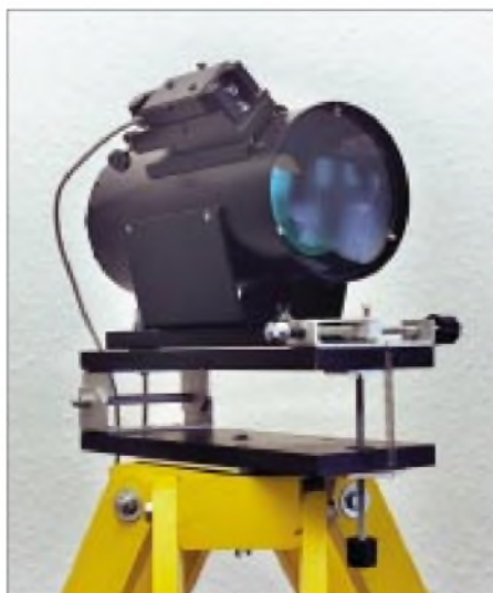
Der Optikkopf mit Linse, Laser und Azimut- sowie Elevations-Einstellung. Fotos: DH3WR
