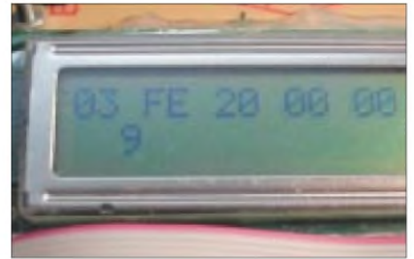
Bild 5: LC-Anzeige im Modus 1. Die Werte haben folgende Bedeutung: 03 = 3 Byte folgen; FE = Empfängeradresse FEH; 20 = 1. Datenbyte; 00 = 2. Datenbyte; Ende des I 2 C-Datenpakets Fotos: DF20AG
