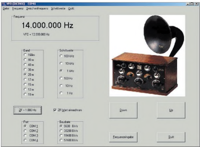
Bild 2: Das vom Autor erstellte Programm Softradio ist speziell für den Einsatz des NWT als Hauptoszillator eines Direktmisch- empfängers zugeschnitten. Screenshot: DK3WX
