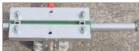
Bild 5: Strahlerrittelstück von unten gesehen, hier für einen Vierkantboom
