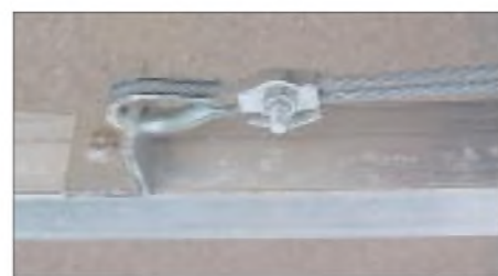
Bild 25: Stahlseil mit Kausche und Kasten-klemme zur Abspannung des Booms
