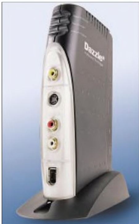
Dazzle Hollywood-Bridge: ein Konverter zwischen Analog-Video und Digital-Firewire
