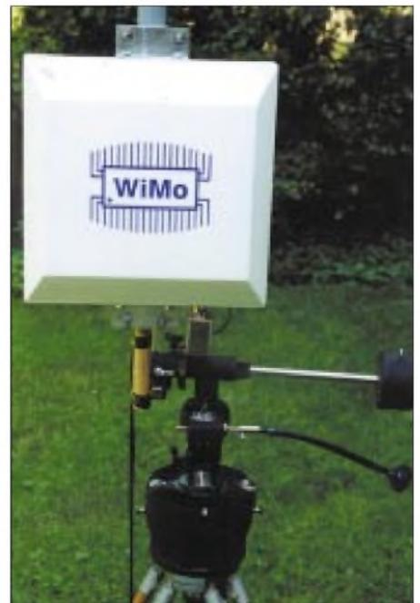
Bild 1: Ansicht der Planarantenne PA-13 R20 auf einem Stativ Foto: DC9ZP
