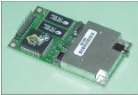
**Bild 4:** Eine zweiseitige SMD-Bestückung ermöglicht eine geringe Baugröße.
