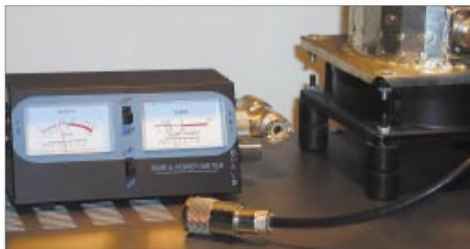
Bild 5: Messungen an einer 80-m-Antenne mit langer Zuleitung bei DK6AE mit handelsüblichem SWV-Messgerät und Dummyload
