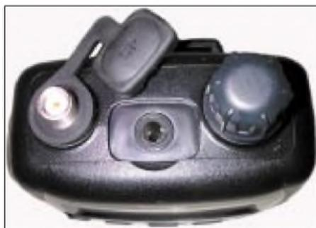
**Zum Antennenanschluss dient eine SMA-Antennenbuchse. An der 3,5-mm-Klinkenbuchse können auch beliebige Ohrhörer angeschlossen werden.**
