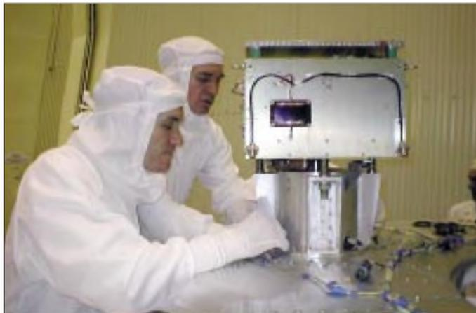
**Der Satellit Rubin-2 bei der Montage auf der Separationseinheit. Vorn erkennt man die beiden N-Anschlüsse, auf die noch die Antennenstäbe geschraubt werden. Die Kabel führen zur AATiS-Amateurfunknutzlast SAFIR-M, die mittlerweile die internationale Bezeichnung AO-49 erhielt. Als Rufzeichen wird DP0AIS verwendet.**
