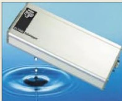
FAT-Dateiformat wie auch geschützte und verschlüsselte Aufzeichnungsformate sind möglich. Alle 12-Bit-Eingangskanäle lassen sich individuell auf die Bereiche: 0 – 5 V, 0 – 10 V, ±5 V, ±10 V bzw. 20 mA einstellen.
