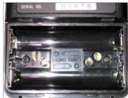
**Die Bohrungen im Boden des Batteriefachs geben dem Lautsprecher mehr Klangvolumen.**
