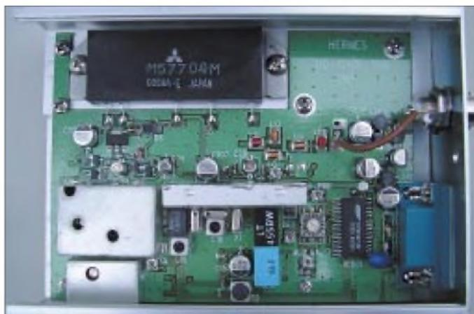
Da alle Datenanschlüsse bis auf DCD über Widerstände entkoppelt sind, mag sich ein Vertauschen von Anschlüssen nicht sofort als fatal erweisen, trotzdem sollte man hier besser einmal mehr als zu wenig kontrollieren und nach dem ersten Funktionstest die Anschlüsse noch ggf. durch Überschrumpfen oder Vergießen schützen.
