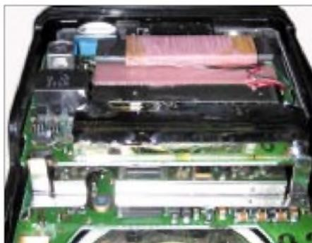
**Blick ins Innere: Der Raum ist mit Platinen in Sandwich-Bauweise und verlöteten Abschirmblechen bis auf den letzten Kubikzentimeter genutzt.**
