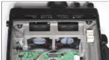
Nach Abnehmen der Akkufach-Bodenplatte kommen u.a. auch die beiden recht großen Lüfter zum Vorschein.
