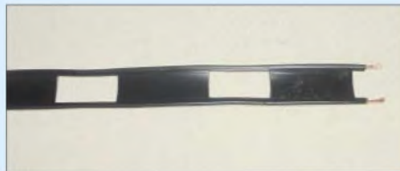
Bild 1: Symmetrische 450-Ω-Speiseleitung US-Wireman – im Amateurfunkfachhandel erhältlich
