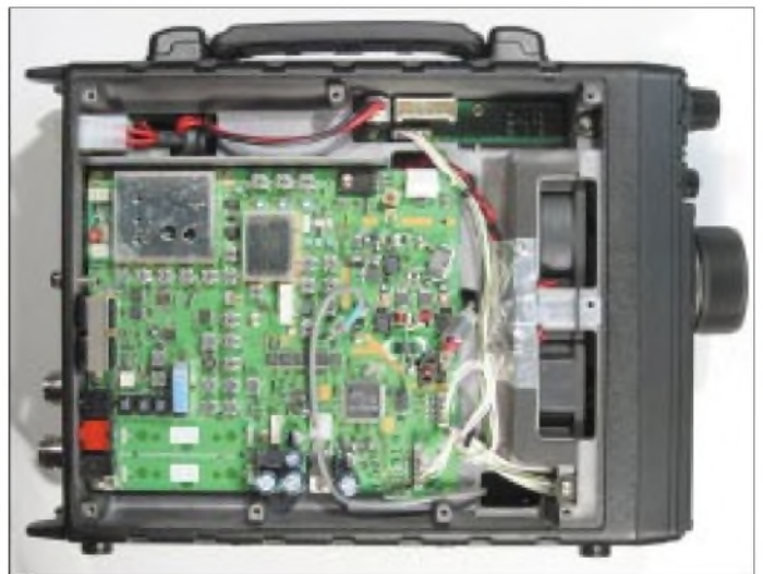
Ein Blick auf die obere Leiterplatte mit dem Empfänger. Links unten im Bild der Platz für zwei optionale (mechanische) 455-kHz-Collins-Filter, darüber das standardmäßig genutzte Keramikfilter. Oben ganz links der Referenzoszillator, der sich bei Bedarf durch den stabileren TCXO-9 ersetzen lässt.
