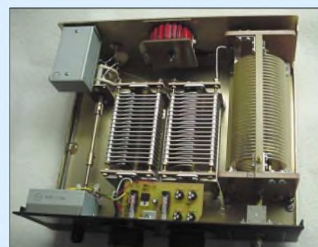
Bild 5: Hochwertiger, in T-Schaltung aufgebauter Antennentuner AT1500CV von Palstar ( www.palstar.de ) Werkfoto: CSR
