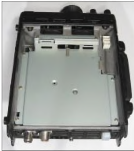
Nach Abnahme des Bodenblechs kann man einen oder zwei Akkumulatoren einsetzen (oben rechts die Anschlussbuchsen). Das Akkufach hat übrigens etwa das Volumen des kompletten FT-817.
