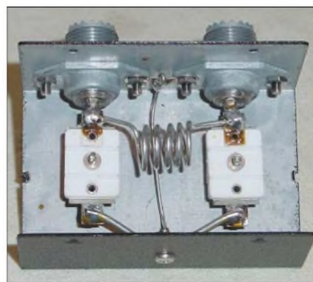
Bild 7: Die umgebaute CB-Matchbox von innen, die Induktivität wurde wie angegeben verringert. Fotos: DK7ZB
