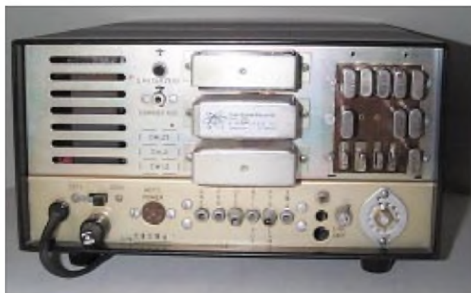
Bild 3: Rückseite des R4C; rechts oben sind die Steckplätze für die Quarze zu erkennen (Schutzdeckel abgenommen).
