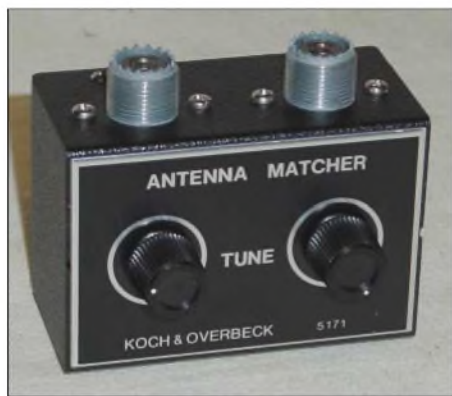
Bild 5: Der originale CB-Matcher für den Einsatz im 6-m-Band
