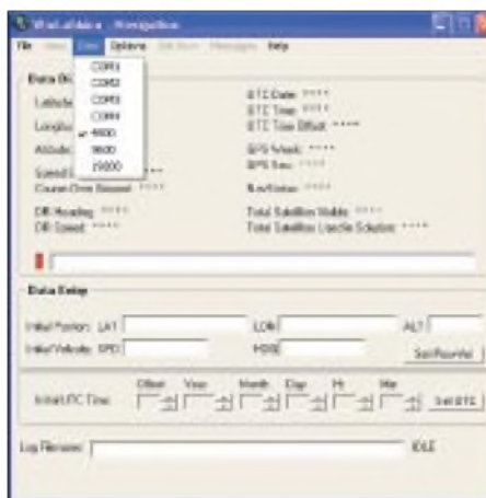
Bild 17: Bei der Software für Windows 2000 und XP sind über das COM-Menü Schnittstelle und Übertragungsgeschwindigkeit einzustellen.
