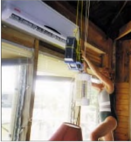
Kühlung ist alles! Hier hat die XYL das Schalt- netzteil direkt vor die Klimaanlage gehängt.
