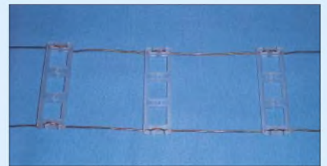
Bild 2: Eigenbau-Hühnerleiter mit Z = 600 \Omega und Spreizern aus Kunststoff Foto: DL7IY
