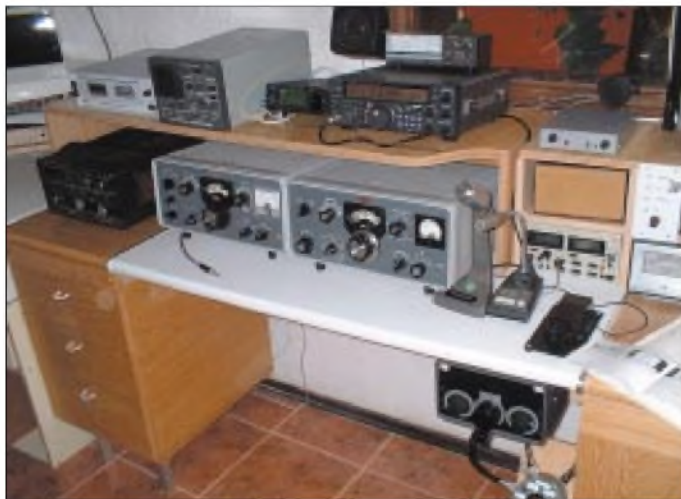
Bild 1: Collins-Line bei EA8AZC, links Sender, rechts Empfänger. Links neben dem Sender steht noch ein uralter Dentrone Linear-Verstärker, der jedoch nicht angeschlossen ist.
