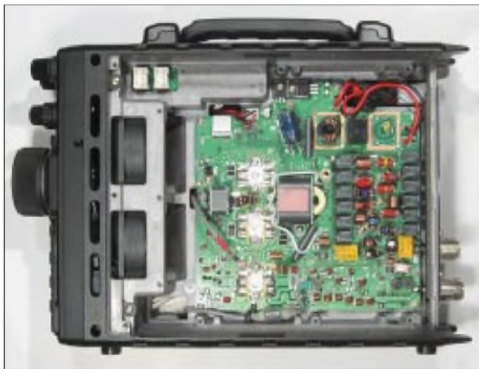
Die untere Leiterplatte trägt im Wesentlichen die Endstufen und die umschaltbaren Antennenfilter. Zum stabilen Druckgussgehäuse gehört auch eine horizontale Mittelfläche zur Montage und zur Kühlung ebendieser Endstufen. Sie wird zudem unmittelbar von den Lüftern bedient.
