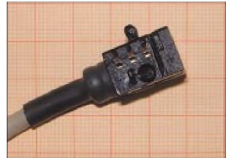
Bild 3: Datenkabel für Garmingeräte (hier nur Anschlüsse für Minus, Data in, Data out)
