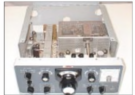
Bild 2: Die einfache Gehäusemechanik – Klappe auf, sechs Schrauben lösen, Chassis rausnehmen, fertig!
