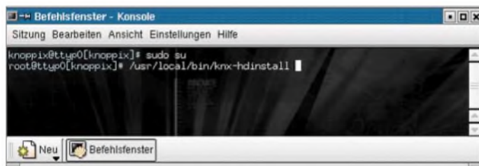
Bild 5: Starten der Installation
