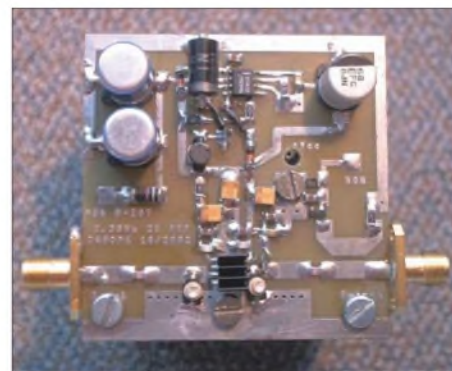
Bild 2: Blick auf die bestückte Platine; unten sind Striplines und MMIC zu erkennen.
