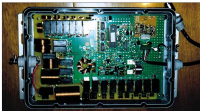
Blick in den geöffneten Tuner. Deutlich zu erkennen ist der Übertrager in der Mitte des Geräts.
