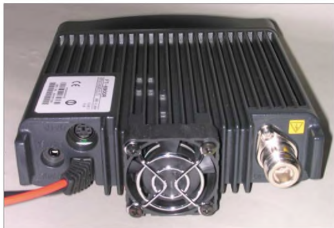
Die Mini-DIN-Buchse ist der Anschluss für Datenfunk. Für 9600 Baud muss der NF-Pegel sehr sorgfältig abgeglichen werden. Der Lüfter kühlt zuverlässig.
