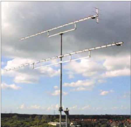
Bild 3: 20-Element-Yagi mit Vierfachreflektor und 23-Element-Yagi im Vergleich
