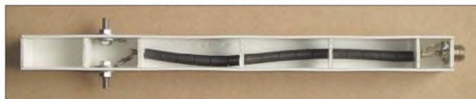
Die Elementlängen des gespeisten Elements gehen aus Tabelle 3 hervor. Wie im Bild 3 zu erkennen, sind die einzelnen Dipole des Multiband-Dipols in einem definierten Abstand übereinander aufzubauen. Je weiter sie auseinanderliegen, desto geringer ist die gegenseitige Beeinflussung, wie bei jedem Multiband-Dipol. Zwischen dem obersten (20 m) und dem untersten Dipol (10 m) sollten etwa 50 cm liegen. Ebenfalls ist es wichtig, mit dem 10-m-Dipol einen gewissen Abstand von den Fiber-
