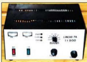
Klein, relativ leicht und mit Netzspannungen zwischen 110 und 240 V zu betreiben ist diese auf einer GU74b basierende KW-Linearendstufe. Foto: DL7DF
