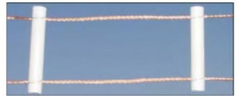
**Bild 9: Selbstgebaute Feederleitung**
