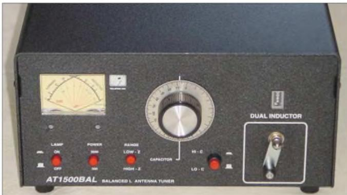
**Bild 1:** Frontansicht des symmetrischen Antennentuners
