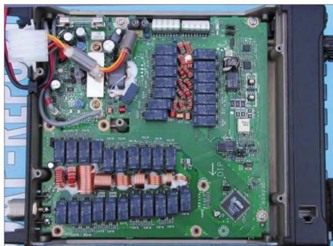
**Bild 4:** Die HF-Platine auf der Geräteunterseite wird von den beiden, mit Relais umgeschalteten Spulensätzen für Eingangfilter (mitte) und Antennentuner dominiert.
