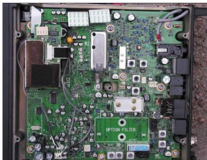
**Bild 3:** Dank SMD wirkt die ZF-/NF-Platine auf der Geräteoberseite relativ „leer“.
