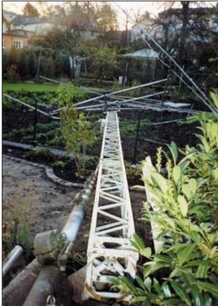
So sieht es aus, wenn einer EME-Station mit 4 x 17-El.-Yagis von M<sup>2</sup> der Gittermast vom Orkan geknickt wird: Jo, DL9MS (JO54), staunte nicht schlecht, als seine 2-m-Antennenanlage in Nachbars Garten lag – natürlich total demoliert!
