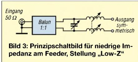
**Bild 3: Prinzipschaltbild für niedrige Impedanz am Feeder, Stellung „Low-Z“**
