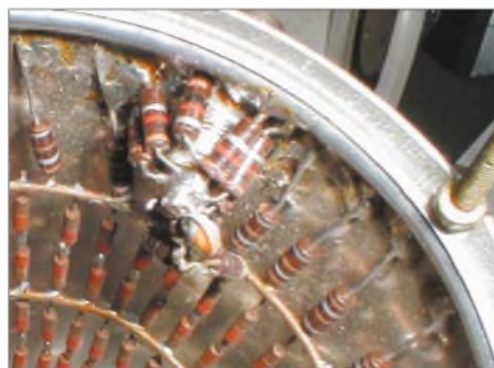
Bild 7: Detailansicht der Auskopplung am Widerstandskegel
