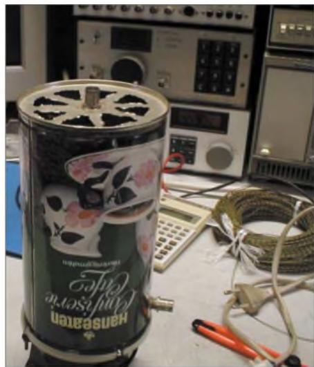
Bild 1: Abschlusswiderstand in der Kaffeedose; oben der Eingang 50 Ω/100 W, rechts unten der Ausgang -30 dB
