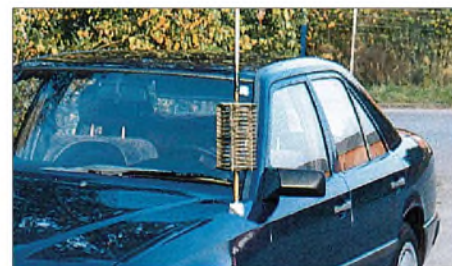
Bild 6: „Gelsenkirchener Mobilantenne“ [5] Foto: DL9AH
