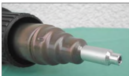
Abb. 2: Heißluftpistole mit aufgesetzter 5 mm-Düse
