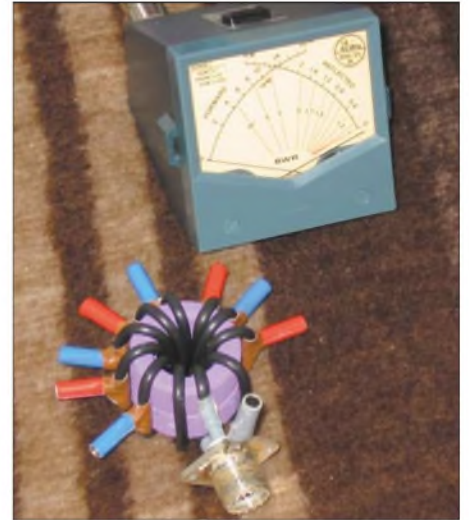
Bild 4: Spartransformator zur Antennenanpassung
