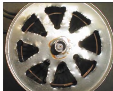
Bild 9: Draufsicht auf den Leistungsteiler, mit Eingangsbuchse und Lüftungslöchern
