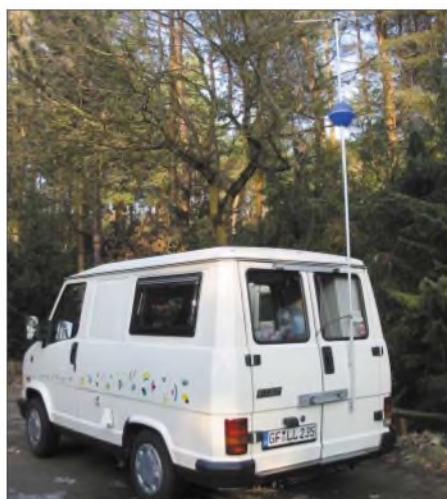
Bild 5: Verlängerte Mobilantenne am Wohnmobil Fotos: DJ6HP (4)
