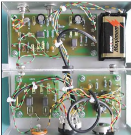
Bild 1: VLF-Empfänger des Autors; oben Empfangsmodul, unten links zuschaltbarer Hochpass, vorn rechts Endverstärker
