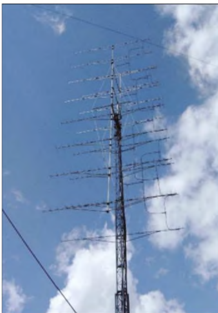
Das ist die neue imposante 16 x 21-Ele.-Antennengruppe für 70 cm bei DL6NAA, die zum Mai-Contest eingeweiht werden konnte.
