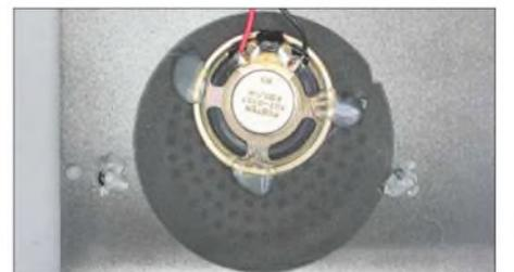
Der Original-Lautsprecher wurde durch ein kleineres Pendant ersetzt, das ebenfalls mittels Heißklebers befestigt wurde.
