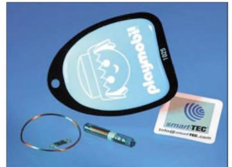
**Ein Beispiel für die kontaktlose Datenübertragung ist der Hybrid-Schlüsselanhänger von smart-TEC, z.B. für die Zutrittskontrolle und Zeiterfassung.**
