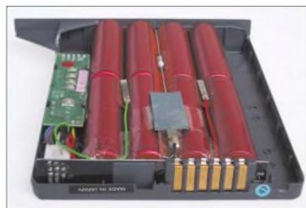
Bild 3: Steckerbelegung des Zweitakkus für HP Omnibook
