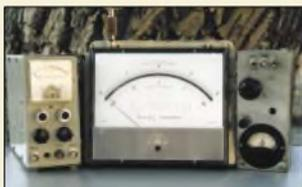
Diese drei Eigenbaugeräte ermöglichen Impedanz- bzw. SWV-Darstellung mit hinreichender Genauigkeit.
