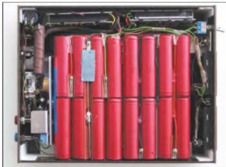
**Bild 6:** Fertig aufgebaute Stromversorgungsbox mit 32 Li-Ionen-Zellen, links der Spannungskonverter mit Ladewiderstand, oben die originale Ladeelektronik, rechts die digitalen Messinstrumente Fotos: DL1AKE
