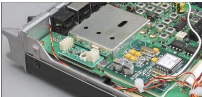
Für den Einbau des ADSP<sup>2</sup>-Moduls muss ein passendes Plätzchen gefunden werden. Beim engen FT-817 kann das unter dem ehemaligen Lautsprecher sein. Die Befestigung erfolgt in der Regel und auch hier vollflächig mittels eines beidseitigen Klebepads aus dünnem Schaumstoff.
