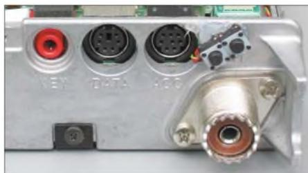
DK7ZT hat die Leitungen zu den per Heißkleber an der Rückfront befestigten Bedienungstasten durch die Öffnung der ACC-Buchse geführt.
