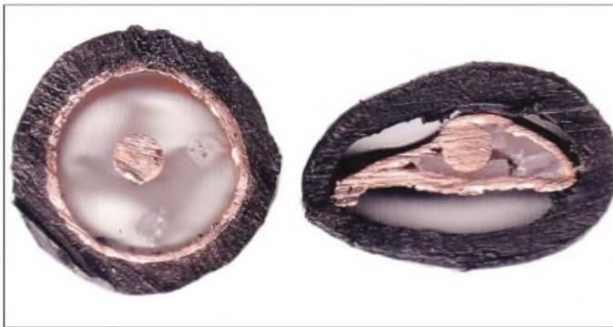
Luftisoliertes Koaxialkabel mit 16 mm Außenleiterdurchmesser – stark deformiert. Nähere Erläuterungen im Beitrag
