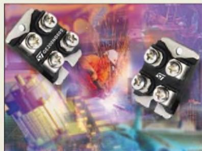
Durch den Aufbau des Bausteins werden im eingeschalteten Zustand geringe Verluste erreicht. Beim Maximalstrom und einer Betriebstemperatur von 25 °C tritt eine Sättigungsspannung kleiner als 1,3 V auf. Spannungen kleiner 1 V sind bei Strömen bis 100 A und 100 °C messbar. Einen Beitrag zur Sicherheit stellt das isolierte ISO-TOP-Gehäuse dar.
