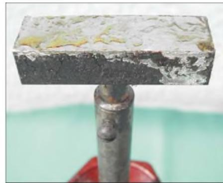
Bild 3: Stempel mit Zinnbad und Kolophonium
