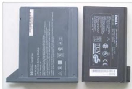
Bild 2: Verschiedene Notebookakkumulatoren: Der große Akku ist ein Backup-Akkumulator mit 2,7 Ah, der kleinere ein neueres Modell mit 3,8 Ah Kapazität
