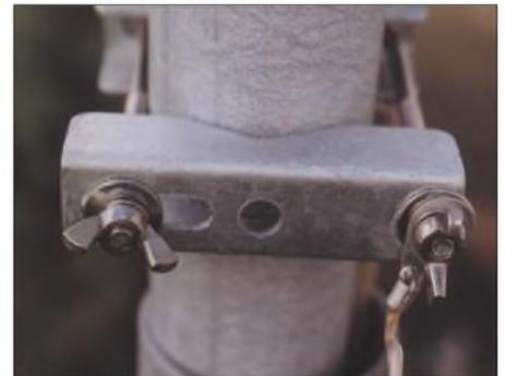
**Bild 3:** Der Balun lässt sich mit einer mitgelieferten Mastschelle befestigen, die auch für die Kontaktierung der Erdungsleitung sorgt.
