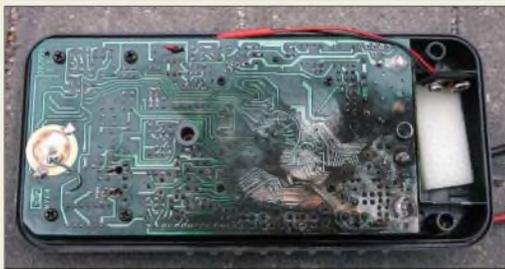
An dieser Stelle sei also angemerkt, dass bei Vielfachmessern beim höchsten Spannungsbereich oftmals Diskrepanzen zwischen dem eigentlichen Messbereich und der maximal zulässigen Messspannung bestehen (Beschriftung beachten!).
