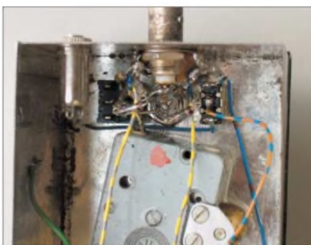
Bild 17: Ganz kurze Anschlüsse zu den Brückenbauelementen sind beim dritten Gerät ein Muss. Die Germaniumdioden sind in Kelchfedern gesteckt und nicht gelötet.
