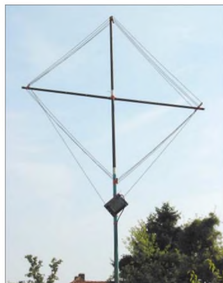
Bild 5: Die quadratische Vierer-Schleife im Einsatz, Seitenlänge 1,52 m, Diagonale 2,17 m Fotos: DK7ZB
