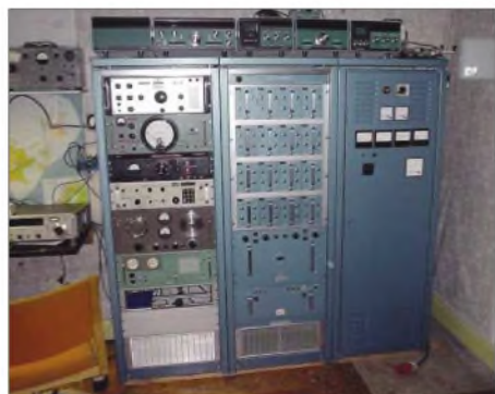
Diesen 1,2-kW-Decca-Sender (Mitte) vom Typ 1876 durfte ich mir bei Kjell, SM1LCA, in Gotland abholen
