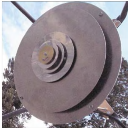
Bild 6: Dieser Dreiband-Patchfeeder für 70, 23 und 13 cm [7] weist eine hinreichende Entkopplung auf, sodass er auch im Duplexbetrieb einsetzbar ist. Foto: WOLMD
