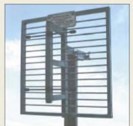
Für Antennenmessungen nach der Vergleichsmethode: **023/SGA**
