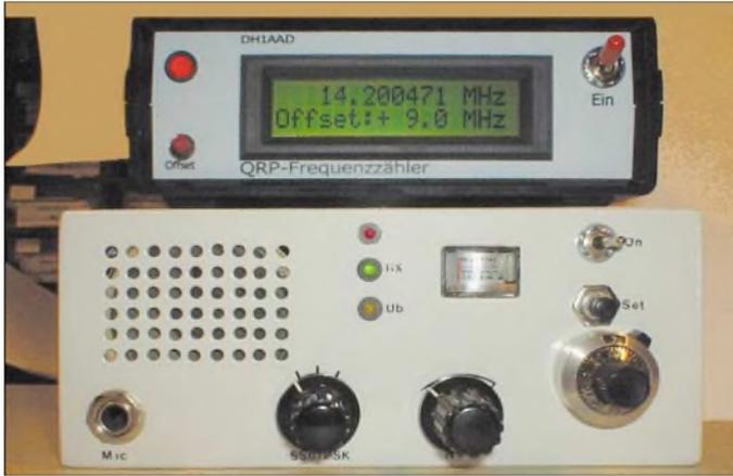
**Bild 1:** Der Prototyp des Zählers zeigt bei seinem Einsatz über einem QRP-Transceiver seine wahre Größe. Fotos: DH1AAD
