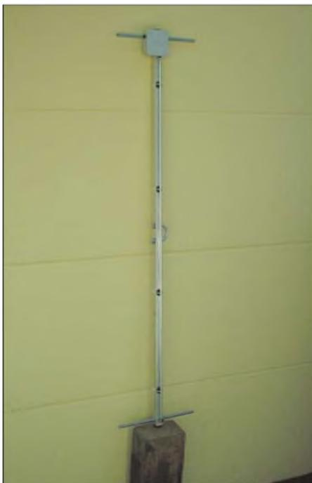
Bild 1: Fertiggestellter Boom mit zwei Gewindestangen
