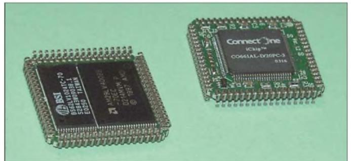
Beim Modul *IIM7100* hat der Hersteller die Benutzung noch einfacher gestaltet. Ein zusätzlicher 8051-kompatibler Controller stellt dem Anwender eine einfach anzuwendende Schnittstelle zur Verfügung, über die er Steuerbefehle und Daten mit bis zu 115 kBit/s übertragen kann.
