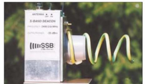
**Bild 13: Kommerziell hergestellter Bakensender für 2400 MHz** Fotos: DC9ZP
