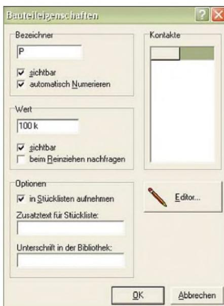
**Bild 5:** Über das Hilfsfenster für die Bauelementeeigenschaften ist auch der Bauteileditor erreichbar.
