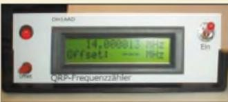
Ein Zähler erleichtert die Bedienung einfacher Funkgeräte und kann durch einstellbare ZF-Offsets an verschiedenen Transceivern betrieben werden.
