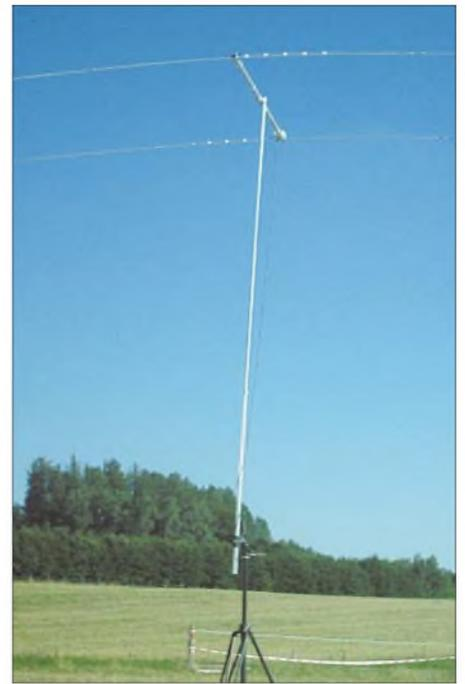
Bild 3: Fertig aufgebaute Antenne, in etwa 5 m Höhe drehbar auf einem Stativ montiert
