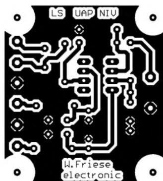
**Bild 80:** Leiterseite der Platine UAP NIV im Maßstab 1:1
