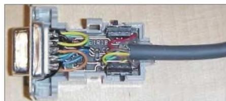
Bild 5: Ansicht der Platine im Steckergehäuse
