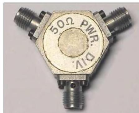
**Bild 2: Beispiel eines resistiven Power-Splitters, 0–18 GHz**
