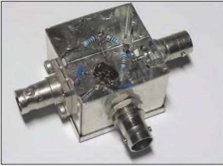
**Bild 5: Aufbau einer Wheatstone-Messbrücke mit Ringkernübertrager FT 37-43 im Weißblechgehäuse 37 mm x 37 mm x 30 mm**
