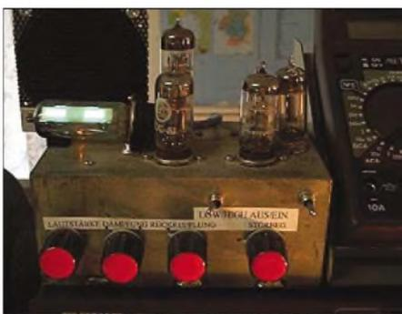
Real radios glow in the dark (echte Radios glühen im Dunkeln): Selbstbau ist auf Langwelle noch gefragt. Foto: DK8AR
