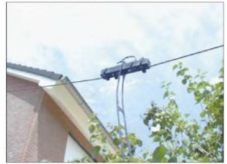
**Bild 10:** Ansicht des Mittenisolators und der symmetrischen Speiseleitung mit herausgetrennten Stegen
