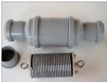
**Bild 2: Wasserdichte Unterbringung von Traps u.a. in HT-Rohren bzw. Fittings aus dem Baumarkt**
