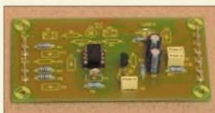
Platine UAP4, verschaltet als Komparator mit Hysterese für Spannungen gleicher Polarität.
