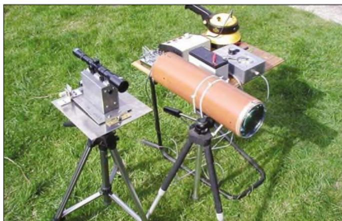
Die Ausrüstung von G0MRF, links der Sender, rechts der Empfänger
