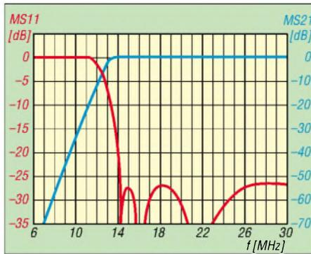
**Bild 13: Anpassung (rot) und Amplitudengang (blau) des 13,9-MHz-Hochpasses**
