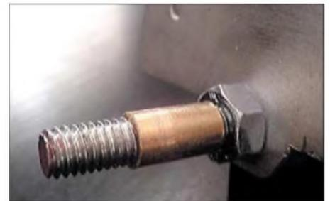
**Bild 7:** Mit Hilfe von Gewindebuchsen ist ein leichtes Drehen der Rotorachse in den Seitenteilen möglich. Fotos: DL7AXF
