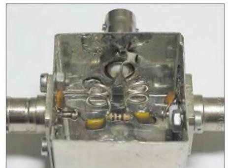
**Bild 10: Versuchsaufbau eines 433 MHz-Wilkinson-Teilers mit L-C-Kreisen im Weißblechgehäuse, Abmessungen 37 mm x 37 mm x 30 mm**
