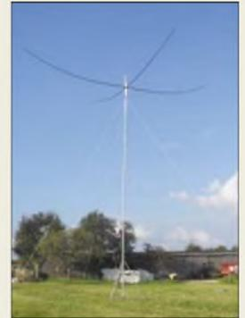
Mit einer Transportlänge von nur 1,2 m und einer Masse von 5,5 kg eignet sich der Spiderbeam sehr gut für Portabelbetrieb, zumal deren Aufbau durch eine einzelne Person möglich ist.
