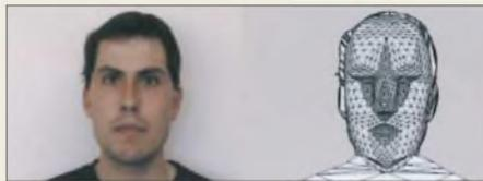
**Ein vom Heinrich-Hertz-Institut Berlin entwickeltes Bildübertragungsverfahren beruht auf einer Zerlegung der Kopf-Schulter-Partie in ein 3D-Modell. Die Übermittlung von 25 352 x 288 Pixel großen Bildern pro Sekunde kommt mit 1 kBit/s aus und eignet sich u.a. für Live-Bildtelefonie von Handy zu Handy.**
