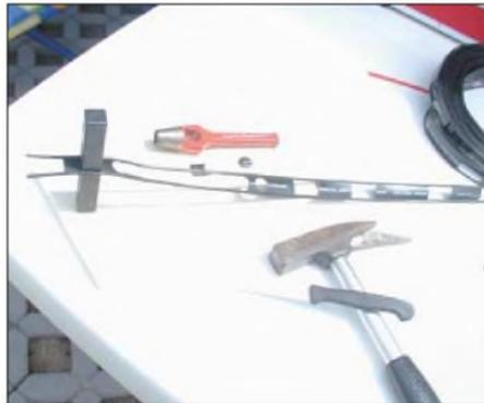
**Bild 7:** Herausretzen der Mittelstege des Wireman-Kabels
