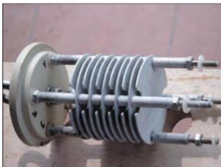
**Bild 1: Ansicht des im Trap enthaltenen Kondensators; Korrosion kann hier die Kontaktgabe verhindern.**
