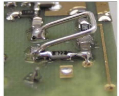
**Bild 16: Die Detailansicht mit der Spule L2 verdeutlicht deren U-Form. Fotos: OK2DXD**
