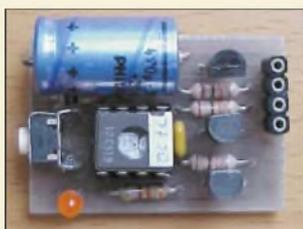
Diese kleine Baugruppe ermöglicht die komfortable Ansteuerung eines Antennentuners vom FT-817 aus, ohne dass man sich durch zig Menüs hangeln muss.
