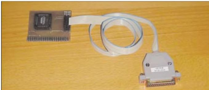
**Bild 1:** Programmier- und FPGA-Modul dienen neben der Software zur Herstellung von FPGAs.
