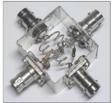
**Bild 18: Versuchsaufbau eines Wilkinson-Teilers „1 auf 3“**
