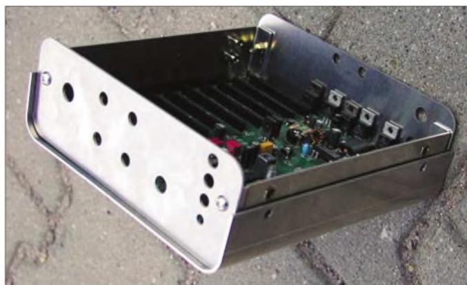
In diesem Gehäuse steckt der Speaky-QRP-Transceiver.
