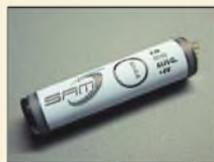
Um Aurora nicht zu verpassen, entstand unter Verwendung eines kommerziellen Sensors ein kostengünstiges Messgerät, im Bild der Sensor, zur Resitrierung von Veränderungen im Magnetfeld der Erde.
