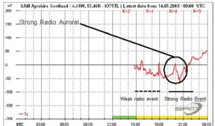
**Bild 6:** Das Magnetogramm einer Radioaurora vom 14. Mai 2003 zeigt die Auswirkungen einer starken Radio-Aurora.
