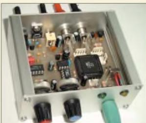
Neben einer komfortablen Morse-schreibmaschine kann das CW-Key-board noch mit einem CW-Trainer im gleichen Gerät aufwarten.
