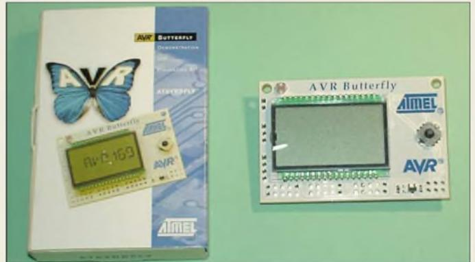
Über einen Miniatur-Joystick lässt sich in Verbindung mit dem sechsstelligen alphanumerischen 14-Segment-Display eine Menüführung realisieren. Die mitgelieferte Firmware reicht von Melodieerzeugung über Uhrenfunktionen bis hin zur Programmierung als Namensschild. Der integrierte Bootlader ermöglicht das Einladen der Firmware ohne zusätzliche Hardware.
