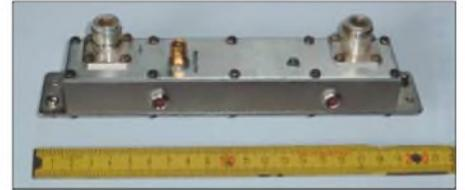
Bild 3: Kommerziell hergestellter Richtkoppler der Firma Fuba
