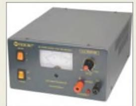
Dieses kompakte und nur 2,5 kg schwere Schaltnetzteil PCS-150 von Microset liefert maximal 50 A bei 5...15 V Ausgangsspannung. Es lässt sich bei reduziertem Ausgangsstrom auch mit 110 V betreiben und kostet bei WiMo 239 €.
