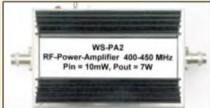
Unter Beachtung einiger Regeln lässt sich eine 70-cm-FA mit Hybridmoduln sehr einfach und sogar ohne Leiterplatte aufbauen. Foto: DC4KU
