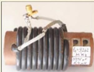
Praktisch aufgebauter koaxialer Sperrkreis aus RG58-Kabel Foto: DG1MFT
