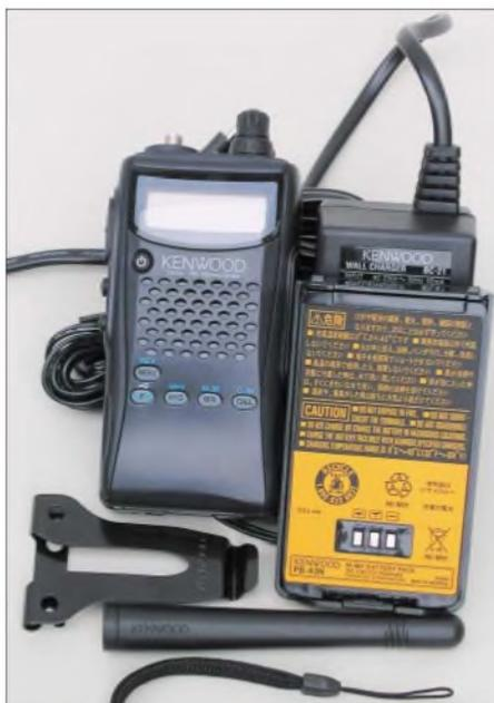
Im Lieferumfang befinden sich der rückseitig aufzusteckende NiMH-Akku, Ladegerät, Handschlaufe, Gürtelclip und Antenne.
