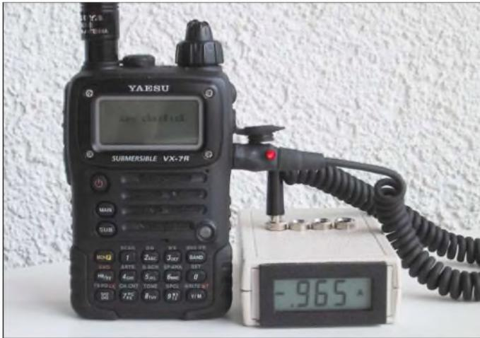
**Bild 5:** Als Beispiel wird ein VX-7R von Yaesu an einer Ladespannung von 12 V geladen, wobei die Akkumulatoren mit rund 1 A belastet werden.
