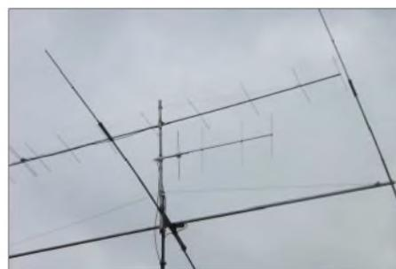
**Bild 8:** 4-Element-Yagi im „Antennenwald“ beim Autor
