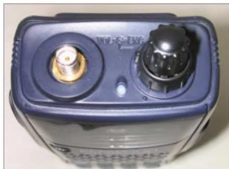
Die Oberseite ist mit der SMA-Antennenbuchse, der RX-/TX-LED und dem koaxial mit dem Hauptabstimmknopf kombinierten Lautstärkerad belegt.
