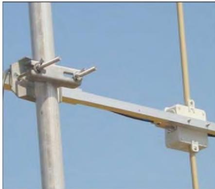
Bild 2: Ansicht der für Abgleichzwecke verschiebbaren Masthalterung
