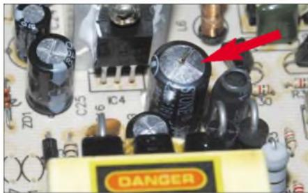
**Bild 2: Heutige fernbedienbare Unterhaltungselektronik kennt keinen Netzschalter, das Netzteil läuft ständig durch. Nach zwei Jahren sind bei Billigplayern, wie hier beim Yamakawa 715, die überhitzten Elkos am Ende, sie platzen, blasen ihren Elektrolyt ab und trocknen aus ...**
