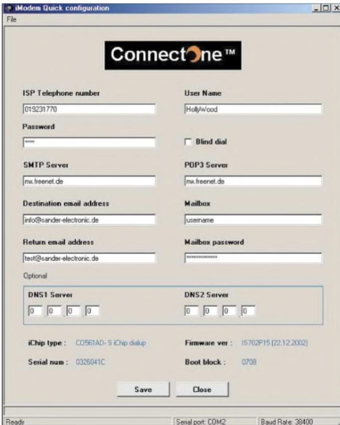
**Bild 36:** Im Menü für die Schnellkonfiguration finden Sie Einstellungen, die identisch zu denen beim iChip-Emulator sind. Durch die geringe Anzahl an einzutragenden Daten ist die Einrichtung des Modems schnell vollzogen.
