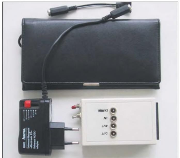
Der erforderliche Ladestrom sollte für den Betrieb mit Solarstrom geeignet sein. Ein optionales Anzeigeinstrument für Lade- und Entladestrom der Li-Ionen-Akkumulatoren ergänzt den Grundaufbau. Bei der Auswahl der Bauelemente legte ich auf geringe Anzahl und hohe Nachbausicherheit Wert. Die Elektronik sollte außerdem kurzschlussfest und überladungssicher sein.
