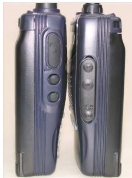
Am handlich geformten Gehäuse liegen sich Sendetaste und Anschlussbuchsen gegenüber. Fotos: Autor
