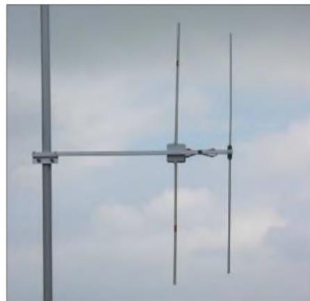
**Bild 9:** Ansicht der 2-Element-Yagi; das dritte Element wird durch den Mast gebildet
