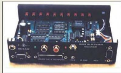
Der **MicroHam-Banddecoder** nutzt die Informationen der CAT-Schnittstelle eines gängigen Transceivers, um über einen optionalen Antennenwahlschalter eine von sechs bzw. zehn Antennen mit dem Funkgerät zu verbinden.
