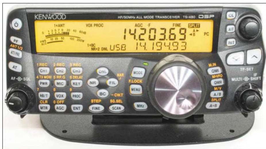
Bild 1: In der Regel dürfte sich beim TS-480 nur das recht kleine und handliche Bedienteil im Gesichtskreis des Nutzers befinden, sodass sich dieses Gerät besonders für beengte Verhältnisse sowie Mobilbetrieb eignet.
