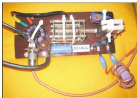
Bild 1: Schaltungsaufbau der Anpassung inklusive Servomotor
