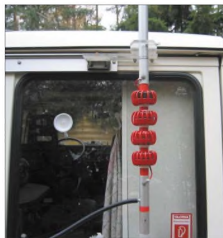
Bild 2: 40-m-Ringkernspule in Höhe des Heckfensters am Wohnmobil des Autors
