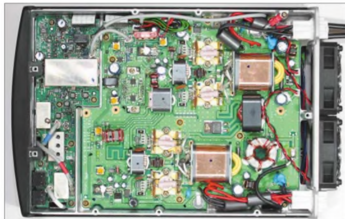
Bild 11: Als Pendant der Blick in einen TS-480SAT (Schirmbleche abgenommen). Den Platz der einen Endstufe nimmt hier ein recht leistungsfähiges Antennenabstimmgerät ein.
