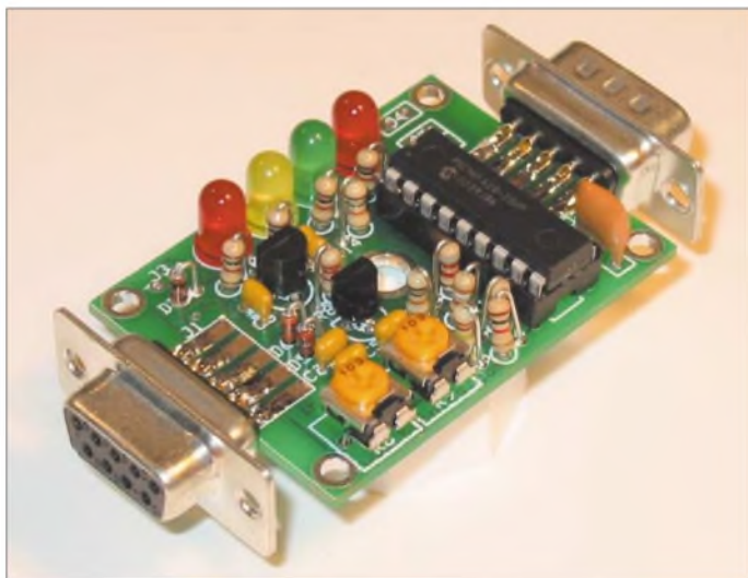
Viel ist nicht dran an der WX-Trak -Platine, die aber trotzdem den bisher notwendigen PC nebst TNC für die Einspeisung von Wetterdaten ins APRS-Netz ersetzen kann.
