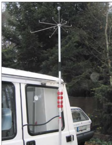
Bild 4: Konstruktionsbeispiel der Antenne am Heck des Wohnmobils
