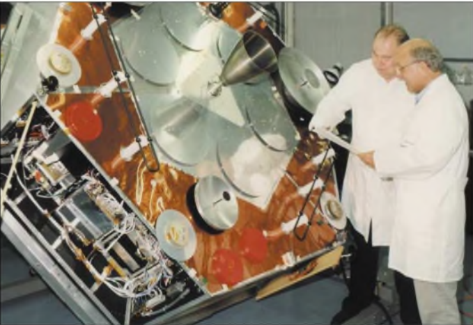
Bild 1: Peter Gülzow, DB2OS (links), und Prof. Karl Mainzer, DJ4ZC, bei der Integration des AO-40 im Labor; im Vordergrund sind die Antennen zu erkennen.
