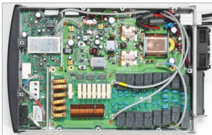
Bild 10: Blick von unten in einen TS-480HX (Schirmbleche abgenommen). Deutlich zu erkennen bei den etwas versetzt angeordneten 100-W-Endstufen, die über Koppelnetzwerke zusammengeschaltet wurden.
