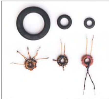
Bild 2: Verschiedene Ferrit-Ringkerne und Bewicklungen. Der Kern links unten hat viermal sechs Windungen, tetrafilär gewickelt.
