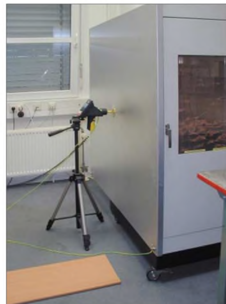
ESD-Pistolen-Kalibrierung mittels Target und Oszilloskop in einem Faradayschen Käfig Werkfoto
