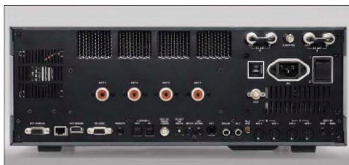
Die Rückseite des IC-7800 mit vier PL-Antennenbuchsen und vielen weiteren Anschlußmöglichkeiten Fotos: Werkfotos
