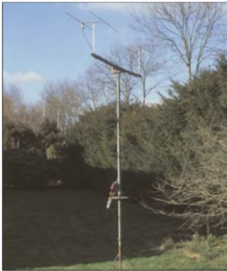
Bild 1: Ansicht der beschriebenen Peileinrichtung mit zweimal HB9CV
