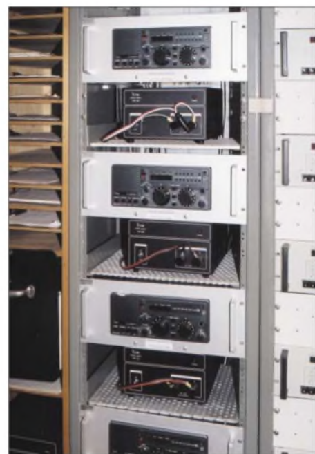
Vier Transceiver IC-M700TY von Icom kommen bei der Ansteuerung der 10-kW-Endstufen zum Einsatz – die Endstufen selbst stammen von Collins. Fotos: Roleder
