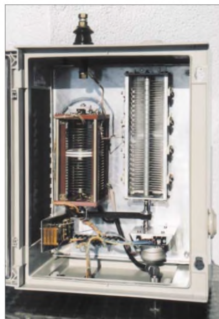
Bild 3: Antennentuner im spritzwassergeschützten Gehäuse, rechts unten Motor und Getriebe, oben der Antennenanschluss
