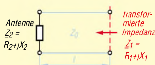
Bild 10: Impedanztransformation an einer Leitung mit der Impedanz Z_0 und der Länge l
