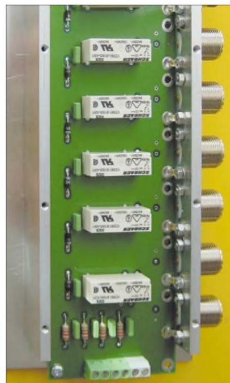
Bild 3: Ansicht der auf einer 222 x 66 mm 2 großen Platine bestückten Umschalteneinheit; die Relais von Schrack [1] haben Kontakte mit Goldauflage und schalten 8 A bei 240 V.
