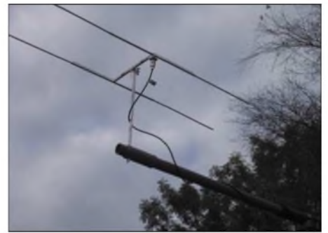
Bild 2: Montage der zerlegbaren HB9CV am Antennenträger
