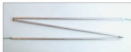
Einige der je 6 mm starken Silberröhrchen der Antenne von A-Sat 137
