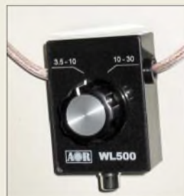
Die aktive Empfangsantenne mit einer etwa 43 cm x 43 cm quadratischen Drahtschleife, hier im Bild die Verstärkerbox, ist vorzugsweise für den Empfangsbetrieb auf Reisen etc. gedacht.
