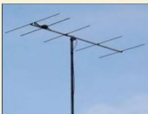
Auch in einem scheinbar ausgereizten Bereich wie dem 144-MHz-Band lassen sich durch ausgeklügelten Eigenbau noch Höchstleistungen vollbringen. Zwei vorgestellte Yagis holen aus 1,5 bzw. 2 m Länge das derzeit Mögliche heraus.
