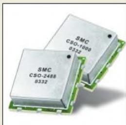
Diese modernen Keramik-VCOs gestatten eine einfache Erzeugung hochstabiler Taktfrequenzen im UHF- und SHF-Bereich. Sie sind ab etwa 80 € zu haben.
