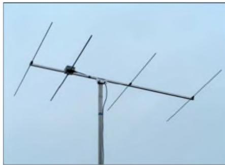
**Bild 5:** Die 4-Element-Yagi beim Vermessen
