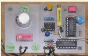
Eine Automatik zur Abschaltung von Batterien bzw. kleinen Netzteilen hilft Kosten für Neuanschaffung oder Strom zu sparen. Foto: Smilde
