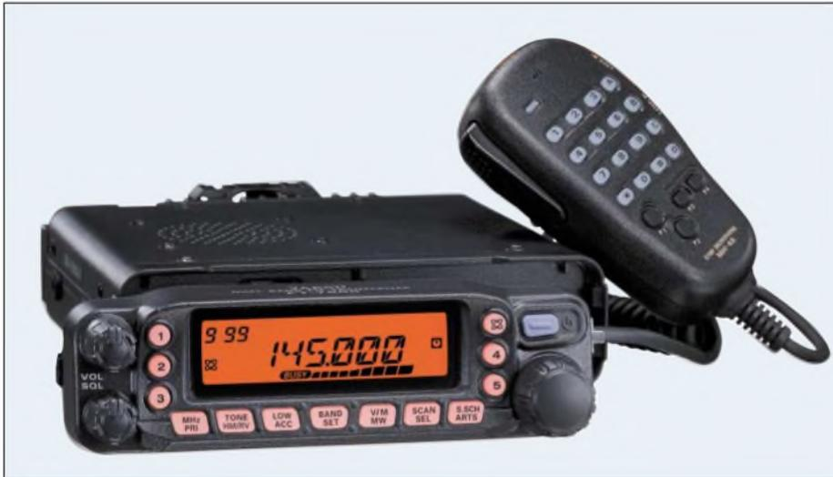
So traf der Vierbander FT-8900R [1] in Deutschland die Vorstellungen der Funkamateure kaum, da hierzulande FM im 10-m-Band nur wenig genutzt wird und Mobilbetrieb auf 6 m für die wenigen Inhaber einer 50-MHz-Sondergenehmigung überhaupt nicht zulässig ist.
