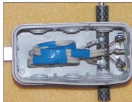
**Bild 14:** Eine andere Variante der Anpassdose mit RG-188U-Teflon-Kabeln
