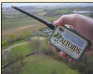
APRS hat sich, u.a. dank dem leicht aufzubauenden Tiny Trak, zu einer beliebten Spielart bei Packet-Radio entwickelt. Der als Bausatz erhältliche Pocket Tracker beinhaltet zusätzlich einen kleinen Sender und stellt daher eine eigenständige Bake dar.
