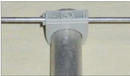
**Bild 10: Installationsklammern als Elementbefestigung für einen Rundboom**
