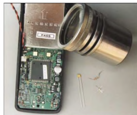
Bild 4: Zum Besichtigen moderner Elektronik braucht man kräftige Vergrößerungen. Bei mir verrichtet ein Linsensystem aus einem Diaprojektor diesen Dienst.
