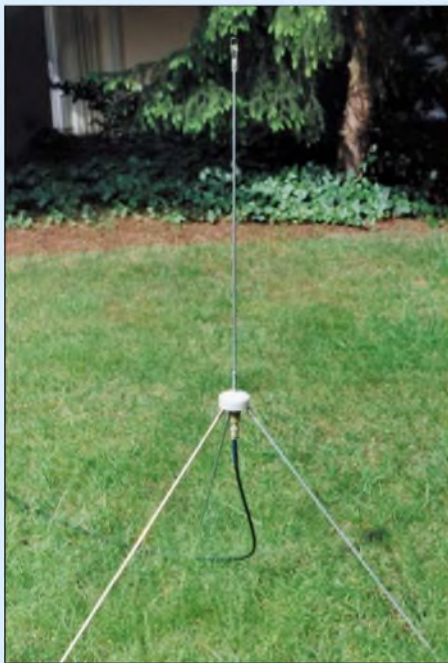
Bild 1: Triple-Leg-Groundplane „wave-basic“ [2] vor dem Einsatz Fotos: DK5FI
