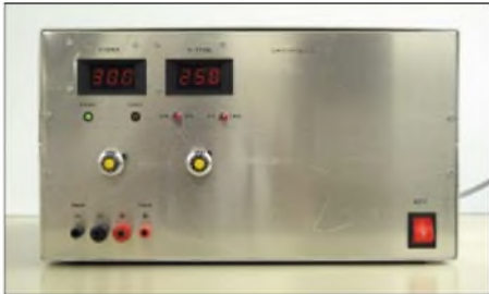
Bild 3: Frontansicht des 25-A-Netzteils mit Anzeigen und Sollwertpotenziometern
