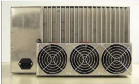
Bild 4: Auf der Rückseite des Netzteils dominieren die drei erforderlichen Lüfter.
