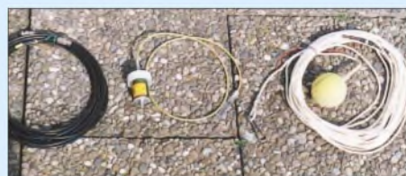
Bild 5: Die als Referenzstrahler verwendete J-Antenne (Mitte) mit Helixkreis zur Anpassung, Koaxialkabel (links) und Wurfseil
