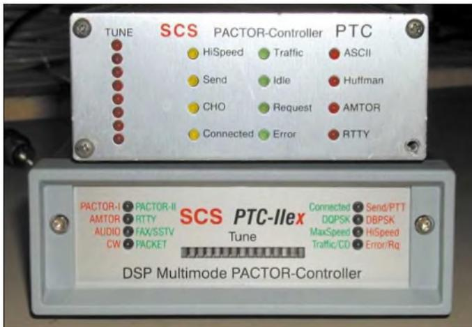
Bild 1: PTC-1 mit-Z80 (oben) und PTC-Ilex (unten)
