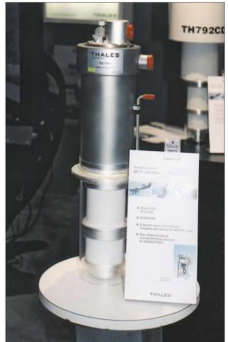
Für UHF-Fernhsender entwickelte Thales Electron Devices eine Röhre, die Leistungen bis 25 kW bei digitalen Betriebsarten gestattet.
