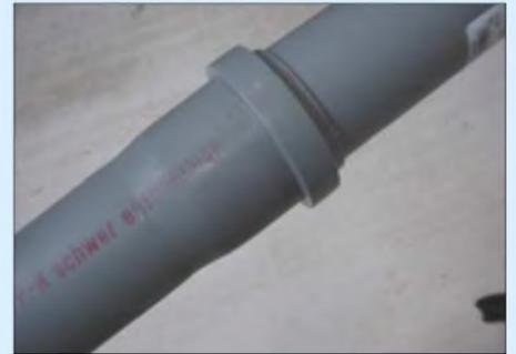
**Bild 3: Die Muffen sitzen straff und sorgen für eine stabile Verbindung zwischen den einzelnen Elementen.** Fotos: DL2SHR
