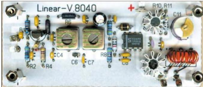
Bild 13: Musterbau des Linearverstärkers
