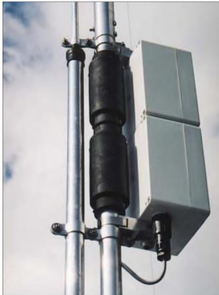
**Bild 2:** Kunststoffgehäuse mit wasserdichter Einführung des Steuerkabels
