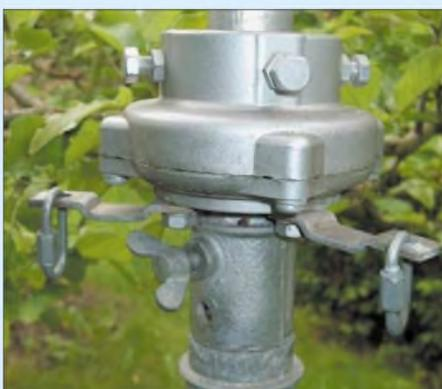
Leichtere Drehbarkeit des Mastes erreicht man mit einem abspannbaren Oberlager.
