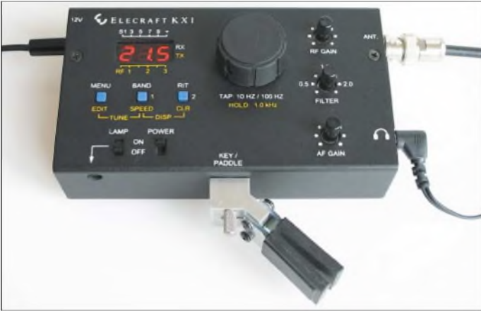
Bild 1: Optionale Paddle-Taste und interner Antennentuner machen aus dem Grundgerät einen universell einsetzbaren Transceiver.
