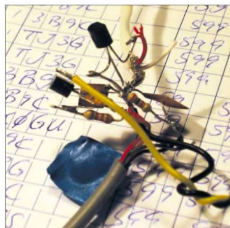
Bild 5: Einfache Schaltungen sind auch in fliegender Verdrahtung beherrschbar
