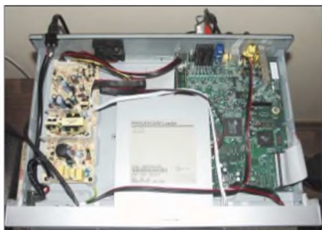
Blick in einen serienreifen DVD-Recorder mit Open-Frame-Schaltteil links, DVD-Brenner in der Mitte sowie Elektronikbaugruppe mit TV-Tuner, Cirrus-Chips CS98201 und CS92288 rechts
