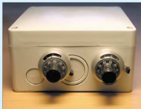
Bild 6: Vorderseite der Anpassbox; deutlich sind die beiden Feintriebe zu erkennen – sie entstammen alten Wendelpotenzioometern.
