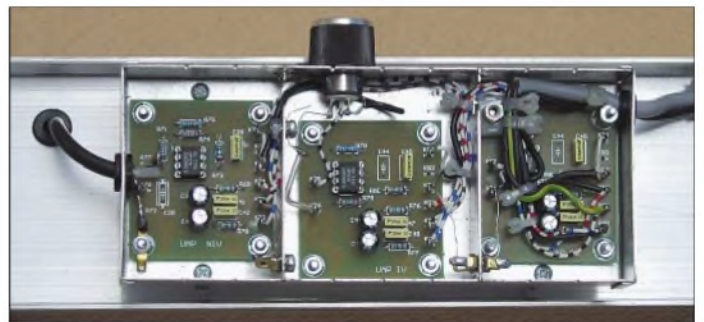
Bild 11: Für die Antenne lassen sich auch, wie hier beim Ortungsgerät 4, Ferritstäbe mit rundem Querschnitt einsetzen. Die genaue Frequenzabstimmung erfolgt mit der variablen Kapazität VK1.
