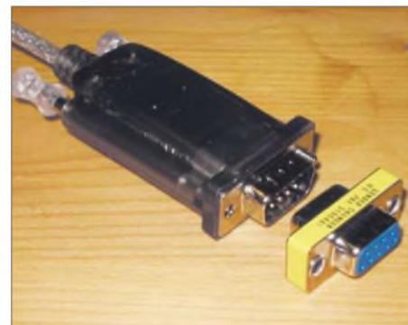
Bild 10: Gender-Changer, z.B. bei Reichelt für 0,69 €
