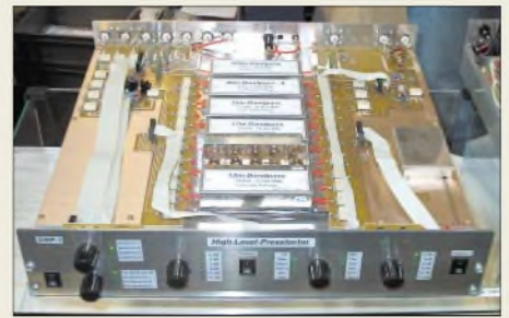
Hohe Spulengüte braucht Platz... Der neue Preselektor von DFE kann sendeseitig Kilowatt-Signale durchschleifen.
