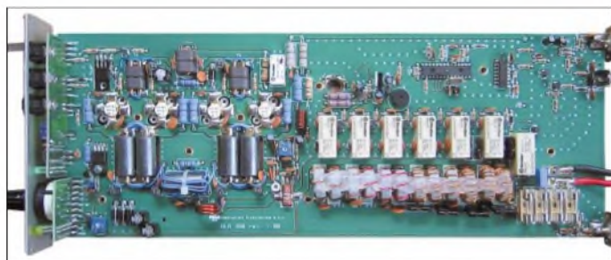
Bild 1: Blick auf die Bestückungsseite der Platine HLA 300; links ist die eigentliche PA zu erkennen, rechts die Tiefpass- filter-Baugruppe
