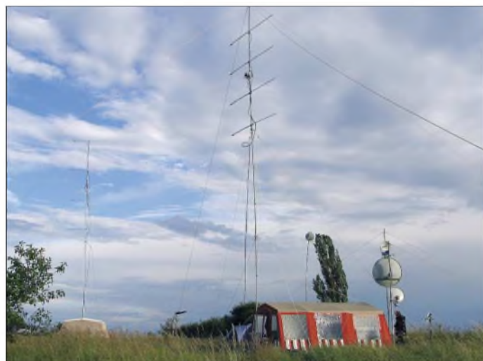
Contestaufbau von DF0YY auf dem Hagelberg (JO62): Im Vordergrund gestocktes Antennensystem für 70 cm sowie weitere Antennen für die SHF-Bänder; im Hintergrund die 2-m-Station mit 4 x 9-El.-Yagis vertikal gestockt.
