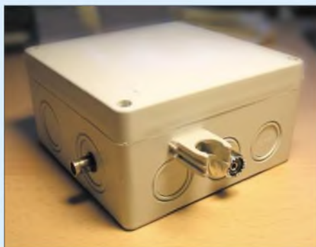
Bild 7: Rückseite des Anpassgerätes, links eine der BNC-Buchsen für die Loop, rechts eine Klemmschelle zur Aufnahme des Trägerrohrs
