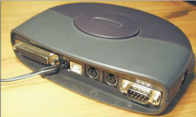
Bild 6: Port-Replikator: Leider keine echte LPT-Schnittstelle Fotos und Screenshots: DL6MHW (10), Werk- fotos (6), Red. FA (1)
