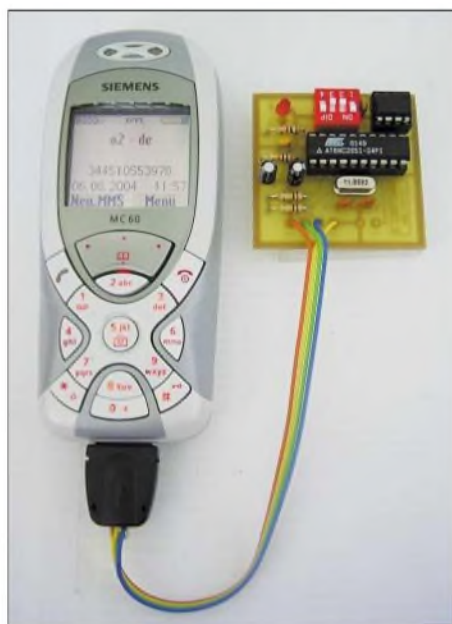
Bild 1: Siemens Handy MC60 in Verbindung mit einem Musteraufbau der Zusatzinheit Handytrack-O
