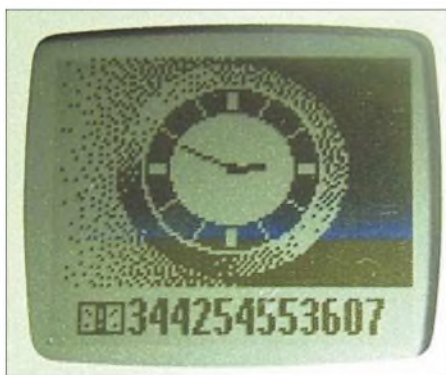
Bild 2: Zwölfstellige Positionsanzeige auf dem Handy-Display im modifizierten Gauß-Krüger-Format; der Rechtswert lautet 3442540, der Hochwert 553607.
