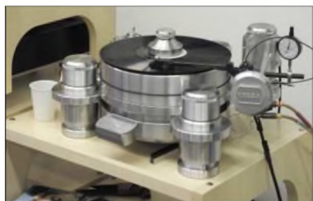
Pressluftbetriebener Plattenspieler? Nein, es ist nur ein Auflagekraftmesser.
