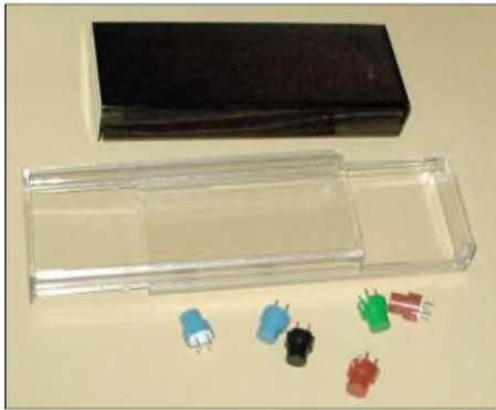
Bild 1: Die HEDDIC-Gehäuse können sowohl für Empfänger als auch für den Sender eingesetzt werden. Im Vordergrund sind die vorgeschlagenen DT6-Tasten zu sehen.
