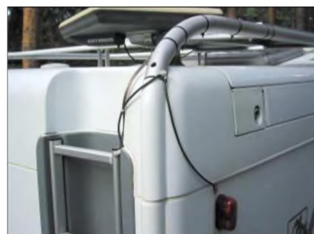
Masseleitungen an allen Ecken: hinten – oben – rechts
