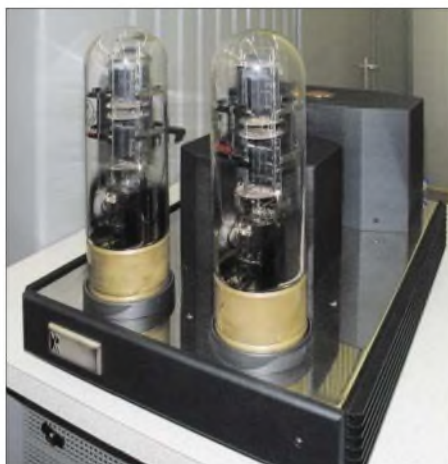
Kronzilla-SD-Röhrenendstufe: MOSFETs treiben die beiden armdicken Audio-Trioden.
