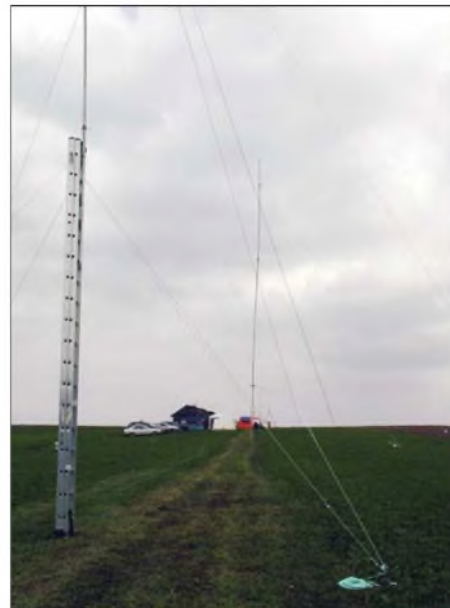
Die Antenne des OV P 41 aus dem vergangenen Jahr. Dieses Jahr wurde sie noch verbessert und mit 15 Top-Load Radials versehen. Fotos: P 41
