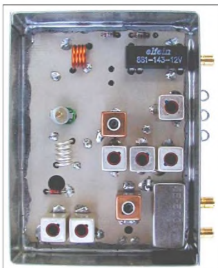
Bild 7: Oberseite des fertig bestückten Frontends im Weißblechgehäuse
