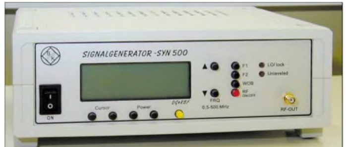
DDS-Signalgenerator mit Netzwerkanalysator bis 500 MHz von Bernd Kaa, DG4RBF – Gesamtsieger im Selbstbauwettbewerb
