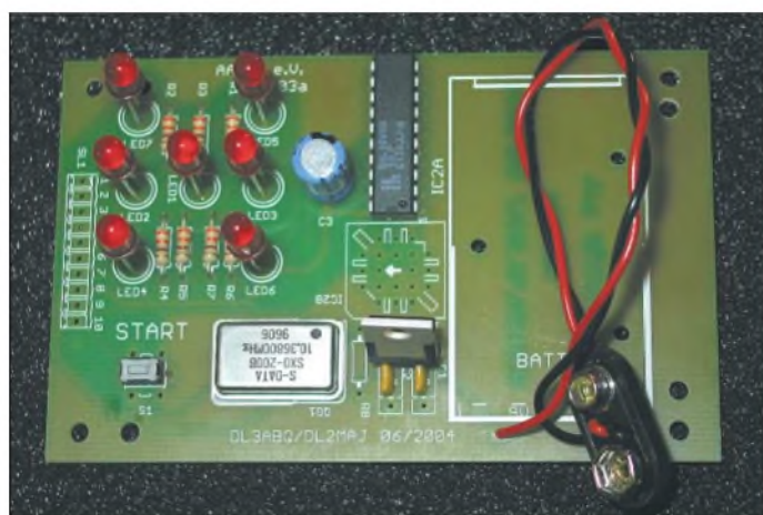
Aufgebaute Platine mit eingelötetem Taster, DIL-GAL und Batterie-Clip, ohne angelötte Winkelsteckerleiste Foto: AATiS
