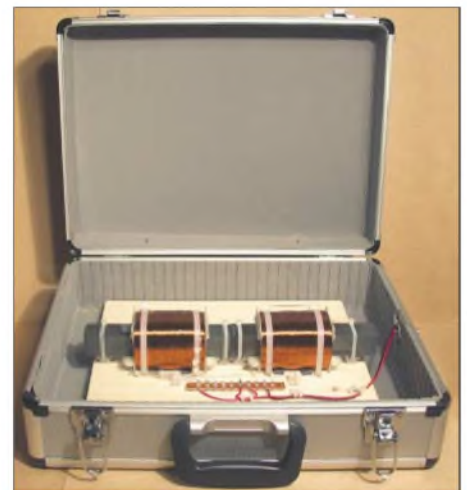
Bild 3: Die in einem Aluminiumkoffer untergebrachte Zweifach-Induktionsspule besitzt einen 36 cm langen Ferritkern mit sehr hoher Permeabilität.
