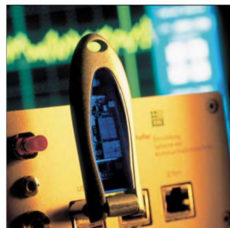
Über einen Forwarding Node mit Bluetooth-Adapter lassen sich PDAs ohne zusätzliche Konfiguration in Netzwerke einbinden.
