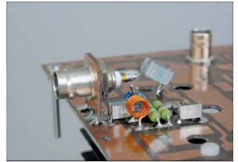
Bild 7: Eingangsseite des Messaufbaus gemäß Bild 2, hier mit Parallelkompensation und Schutzbeschaltung
