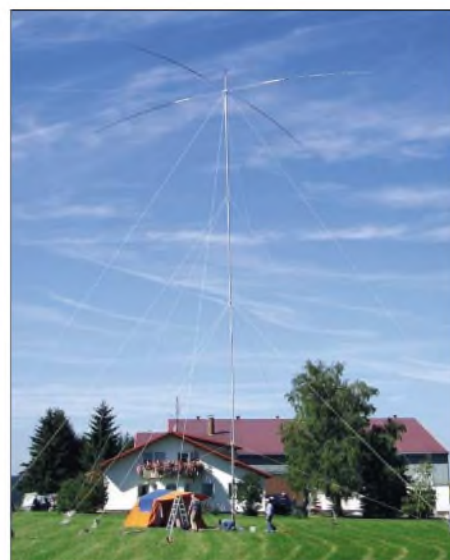
Die 24 m hohe Langwellenantenne Foto: DK1SB
