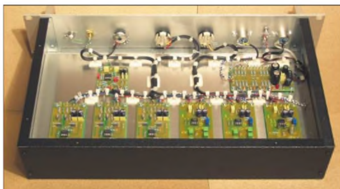
Bild 7: Das Anpassmodul für magnetische und elektrische Antennen lässt sich auch abgesetzt und ferngespeist vom Hauptgerät betreiben.
